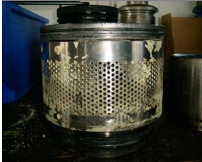
Slika 6-3. Nakupljanje sumpora na sigurnosnom ventilu (Marcogaz, 2022).
