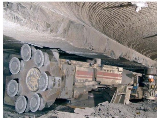
Figure 3-2 Reef Miner MN 220 (Bergbau, 2021)
