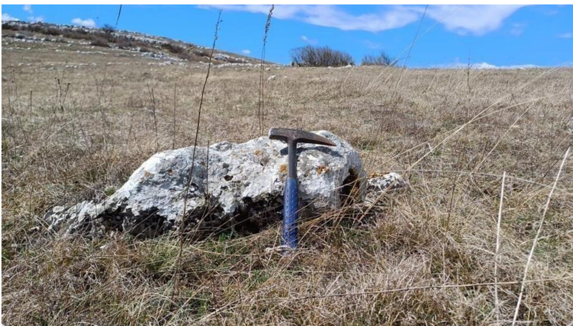
Slika 3-8. Izdanak kasnodijagenetskog donjokrednog dolomita karakteristične šećeraste strukture. Točka istraživanja A 75, koordinate X: 6439402 Y: 4851128.
