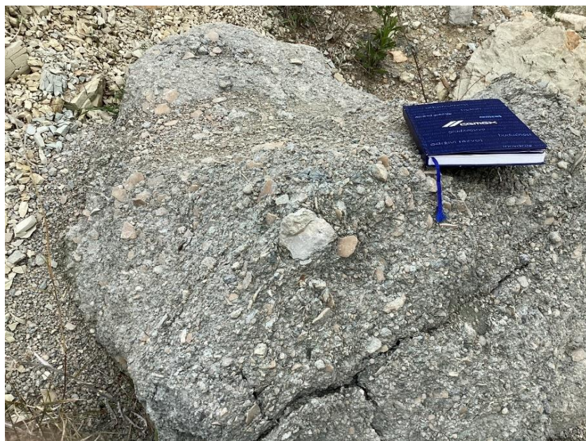
Slika 5-11. Lokalitet kopa „Sv. Juraj – Sv. Kajo“. Trošeni izdanak gdje su u „numulitnim brečama“ vidljive očuvane krupne ljušturice numulita i litoklasti
