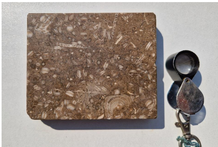
Slika 5-1. Uzorak numulitnog vapnenca floatstone -tipa (Lupoglav) u kojem je vidljiva dominacija ljušturica numulita
