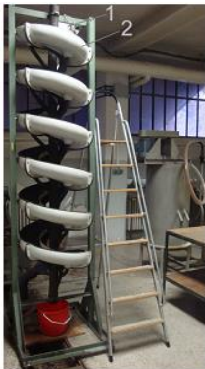
Slika 6-1. Spirala Humphreys RGN fakulteta u Zagrebu (1-bunker za doziranje materijala, 2-žlijeb) (Bedeković i Salopek 2010).
