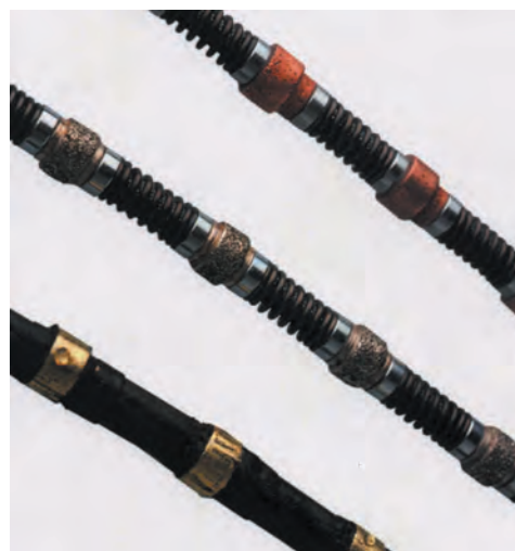
Slika 3. Konstruktije dijamentne žice (galvanizirane perle (gore); sinterirane perle (u sredini); žica obložena plastikom zbog zaštite čeličnog užeta od prebrzog habanja (dolje).
