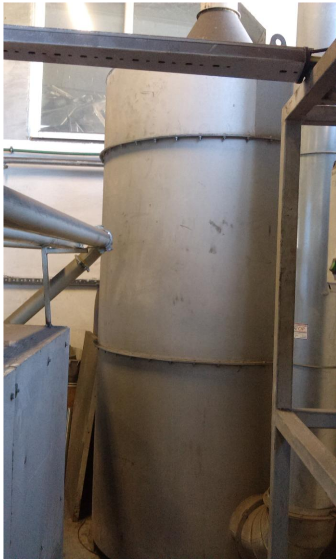
Slika 3-8. Uređaj za filtraciju zraka s aktivnim ugljenom
