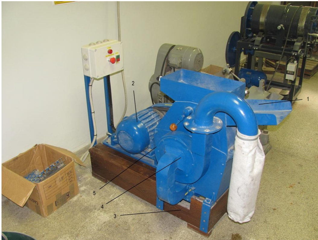
Slika 4-4. Korištena drobilica čekićara sa glavnim dijelovima
