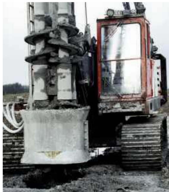
Slika 3-10. Primjeri različitih izvedbi strojeva sa radnim alatom za miješanje ( auger ) (Al-Tabbaa i Perera, 2006)
