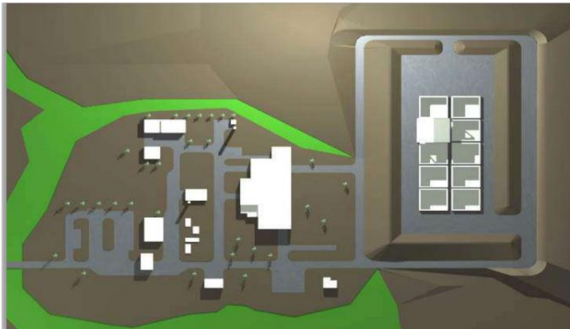
Slika 4-2 Predviđeni koncept površinskog tipa odlagališta NSRAO (Lokner et al., 2004)
