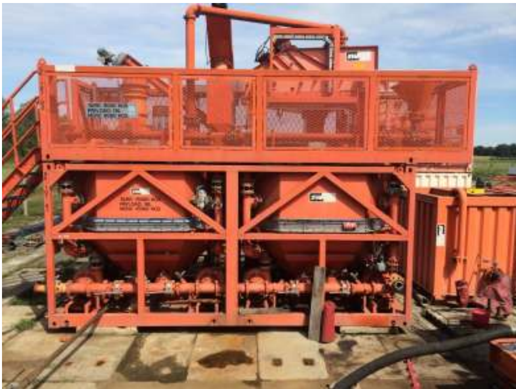
Slika 5-1. Jedinica za pripremu tehnološkog otpada
