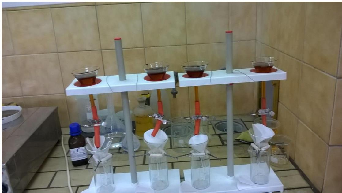
Slika 3 - 6 Aparatura za separaciju mineralnih frakcija teškim tekućinama
