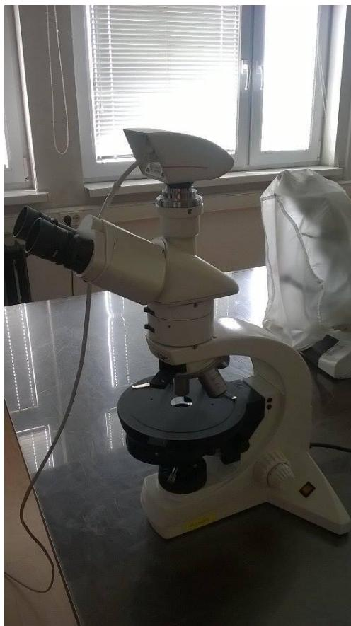
Slika 3 - 7 Polarizacijski mikroskop Leica DM LSP
