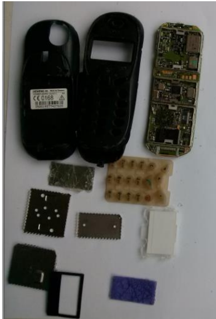
Slika 5-1. Ručno rastavljeni mobilni telefon
