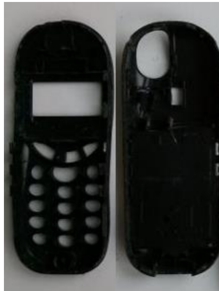
Slika 3-10. Primjer maske mobilnog telefona
