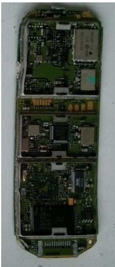
Slika 3-7. Primjer tiskane ploče mobilnog telefona
