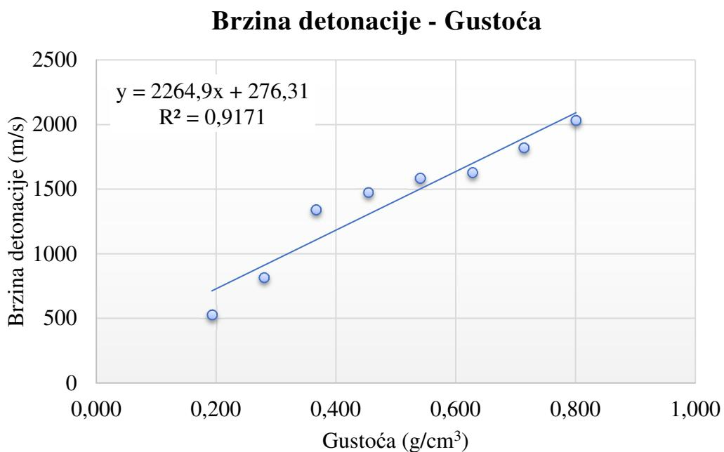
**Slika 6-33.** Zavisnost brzine detonacije od gustoće ANFO-eksploziva s dodatkom matrice kao veziva i EPS-a.
