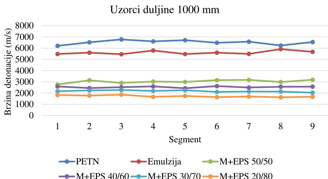
Slika 6-38. Prikaz brzine detonacije po segmentima za uzorce duljine 1000 mm.
