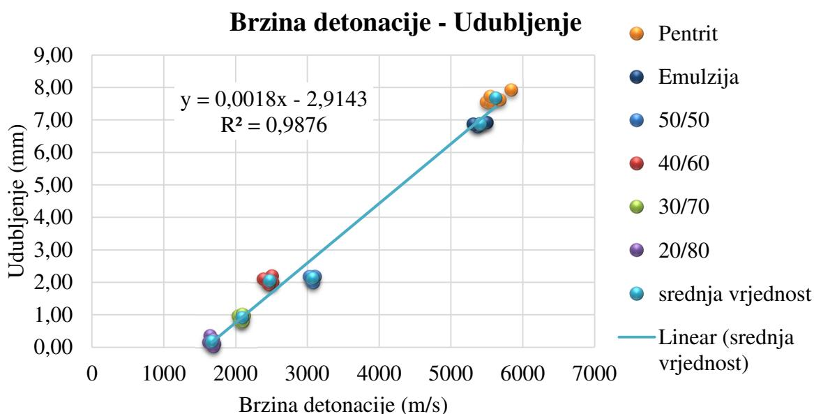
**Slika 6-42.** Zavisnost udubljenja od brzine detonacije eksplozivnog punjenja.
