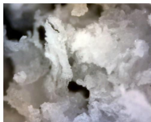
**Slika 6-9.** Struktura mješavine Lambrexa 1 i EPS-a (0,18 mm – 0,25 mm) u omjeru 40:60 (uvećanje 500×, mikroskop Dino-Lite Pro).
