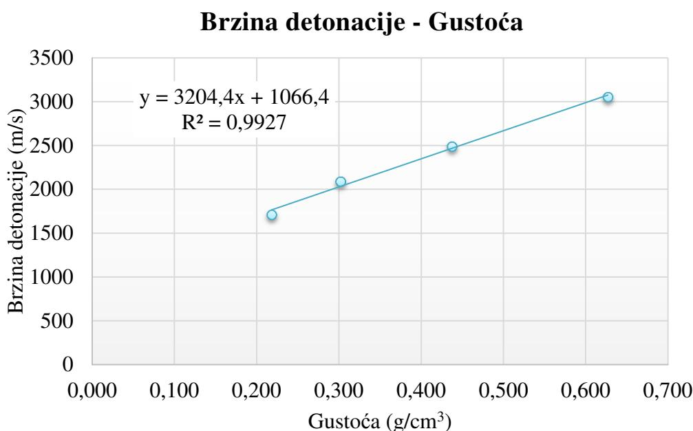
**Slika 6-36.** Zavisnost brzine detonacije od gustoće emulzijske matrice s dodatkom granuliranog EPS-a.
