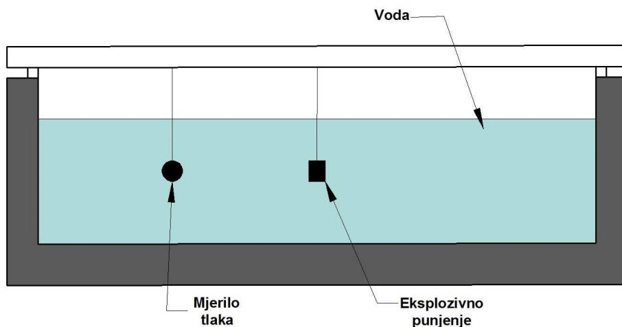
**Slika 3-3.** Shematski prikaz detonacijskog pokusa u vodi (Ester 2005).
