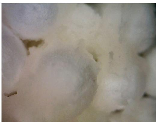
**Slika 6-8.** Struktura mješavine Lambrexa 1 i EPS-a (1,5 mm – 3,5 mm) u omjeru 40:60 (uvećanje 50×, mikroskop Dino-Lite Pro).
