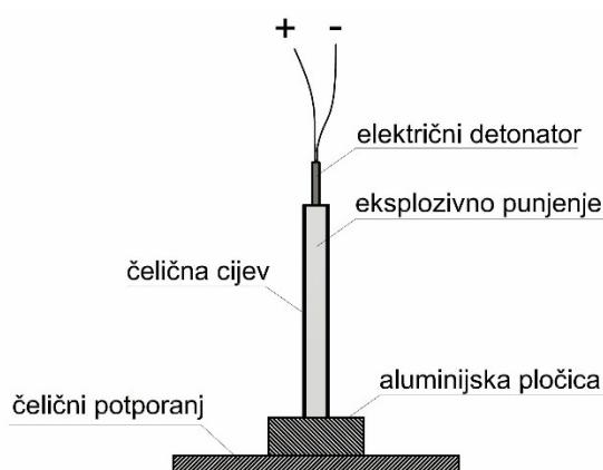
**Slika 6-21.** Shematski prikaz postava mjerena.
