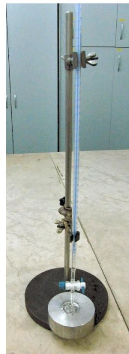
**Slika 6-24.** Određivanje volumena udubljenja na Al pločici.
