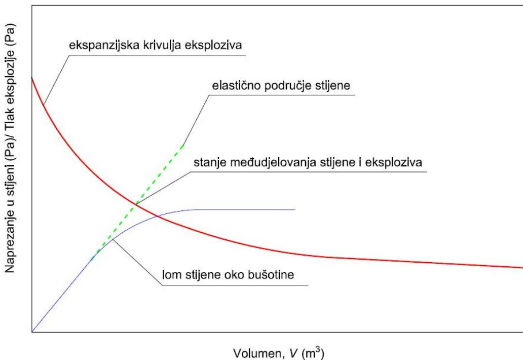
Slika 3-6. Dijagram tlaka plinova i naprezanja u stijeni u odnosu na volumen (Antičević, 2011).
