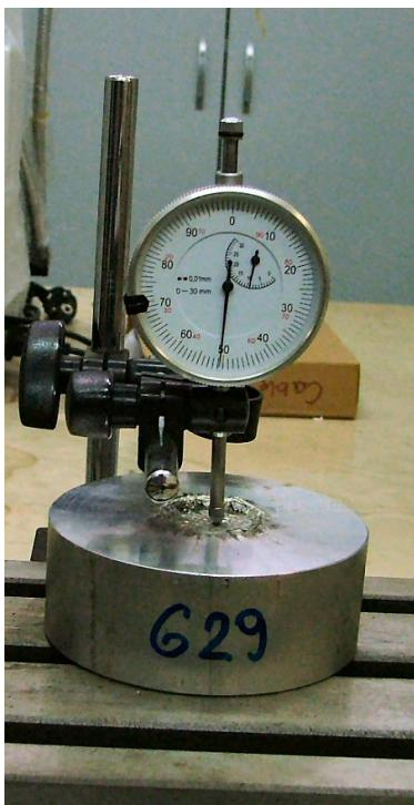
**Slika 6-23.** Određivanje udubljenja na Al pločici.
