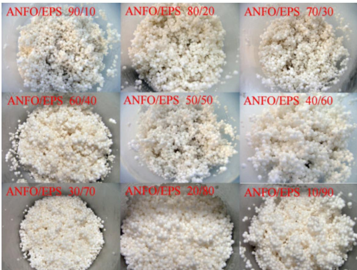
**Slika 6-7.** Izgled pojedinih mješavina ANFO-eksploziva i EPS-a.
