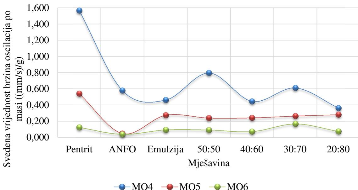
**Slika 6-64.** Svedena vrijednost brzina oscilacija po masi za pojedine mješavine za mjerena u pravcu 2.
