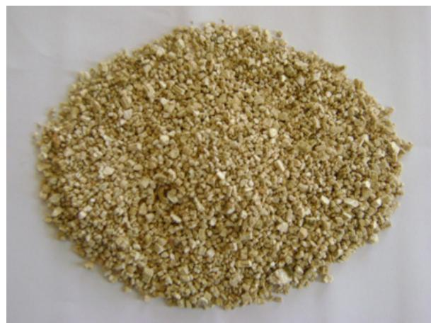
**Slika 4-2.** Zrnca vermiculita (<http://www.bilgisiburada.com/vermikulit-nerelerde-kullanilir>).
