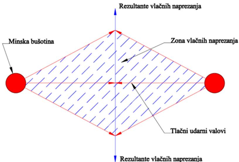
**Slika 3-13.** Nastanak konturne pukotine djelovanjem vlačnih naprezanja (Pisk 2011).
