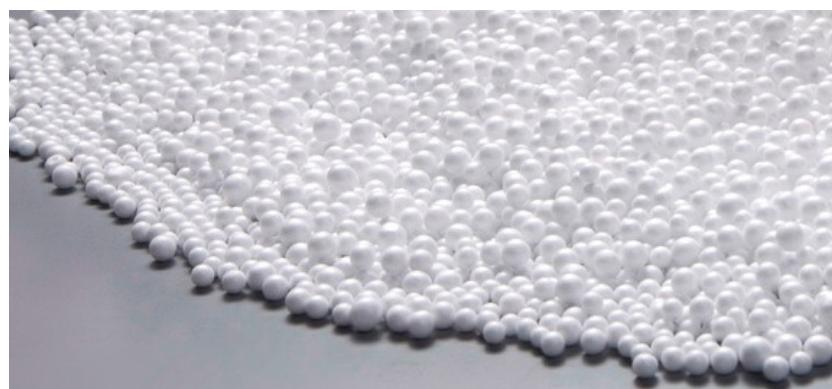
**Slika 4-27.** EPS – ekspandirani polistiren (Iskraplast 2013).
