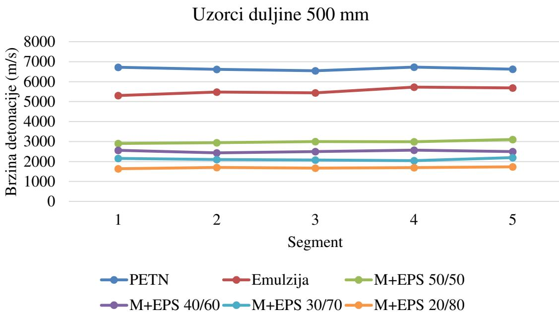
Slika 6-37. Prikaz brzine detonacije po segmentima za uzorce duljine 500 mm.
