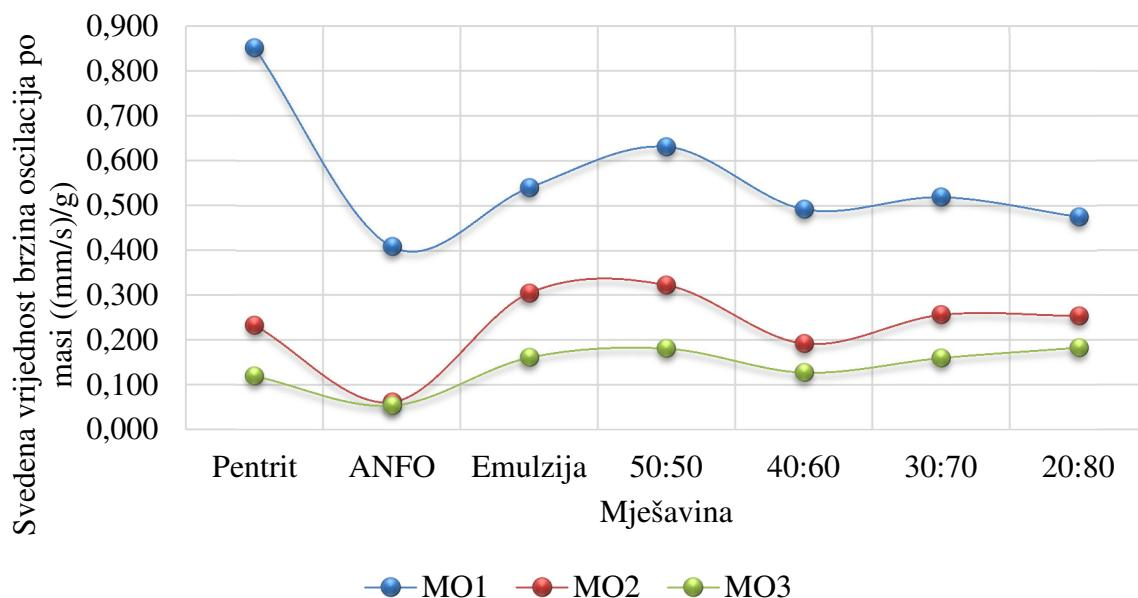
**Slika 6-63.** Svedena vrijednost brzina oscilacija po masi za pojedine mješavine za mjerena u pravcu 1.
