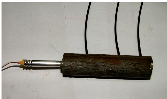
**Slika 6-16.** Fotografija mjernog postava u čeličnoj cijevi unutarnjeg promjera  $\varnothing$  16 mm.
