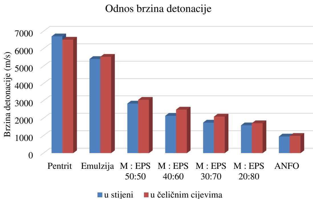
**Slika 6-53.** Dijagram odnosa brzina detonacije u stijeni i u čeličnim cijevima.
