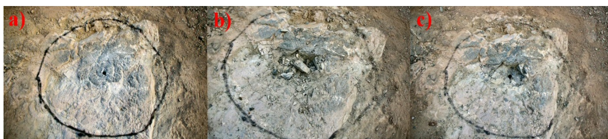
Slika 6-54. Lijevak s najvećim odlomom (M+EPS 40:60).
