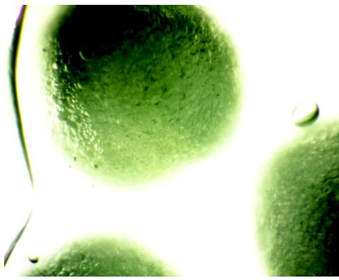
**Slika 6-11.** Mješavina emulzijske matrice i EPS-a u volumnom omjeru 50:50 (uvećanje 40x, mikroskop BIM 313T).
