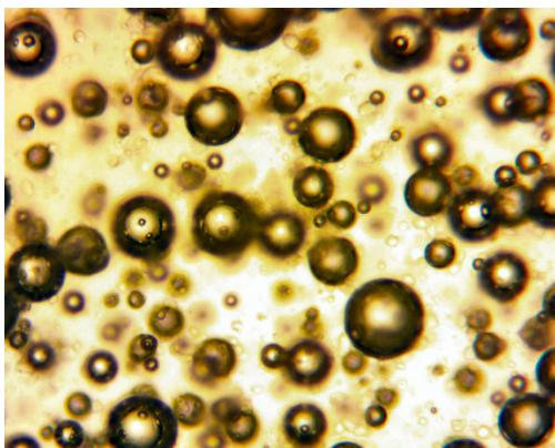
**Slika 6-10.** Emulzijska matrica senzibilizirana mikrokuglicama (uvećanje 200x, mikroskop BIM 313T).
