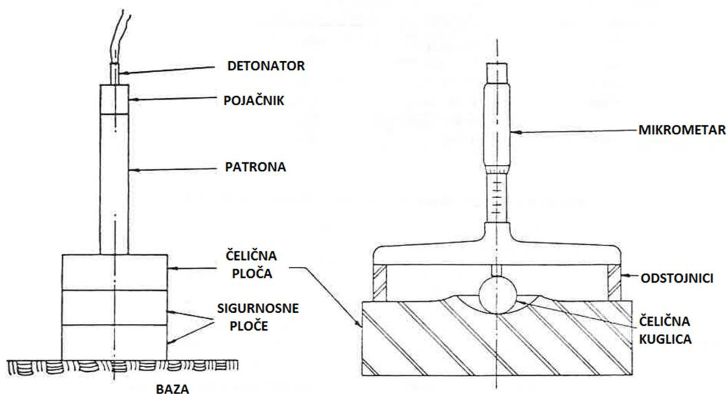
**Slika 6-19.** Postav za izvođenje ispitivanja otiska na čeličnoj ploči (lijevo) i mikrometar za mjerjenja dubine (desno) (Persson et al, 1993).
