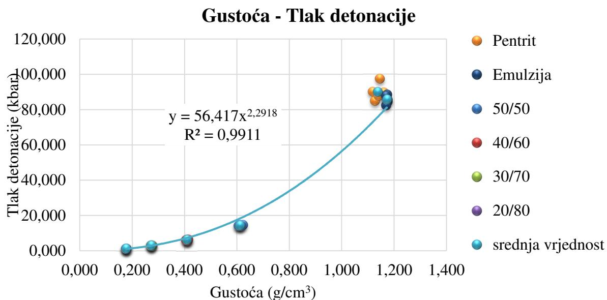
**Slika 6-46.** Zavisnost tlaka detonacije od gustoće eksplozivnog punjenja.
