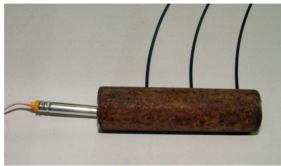
Slika 6-17. Fotografija mjernog postava u čeličnoj cijevi unutarnjeg promjera \varnothing 20 mm.
