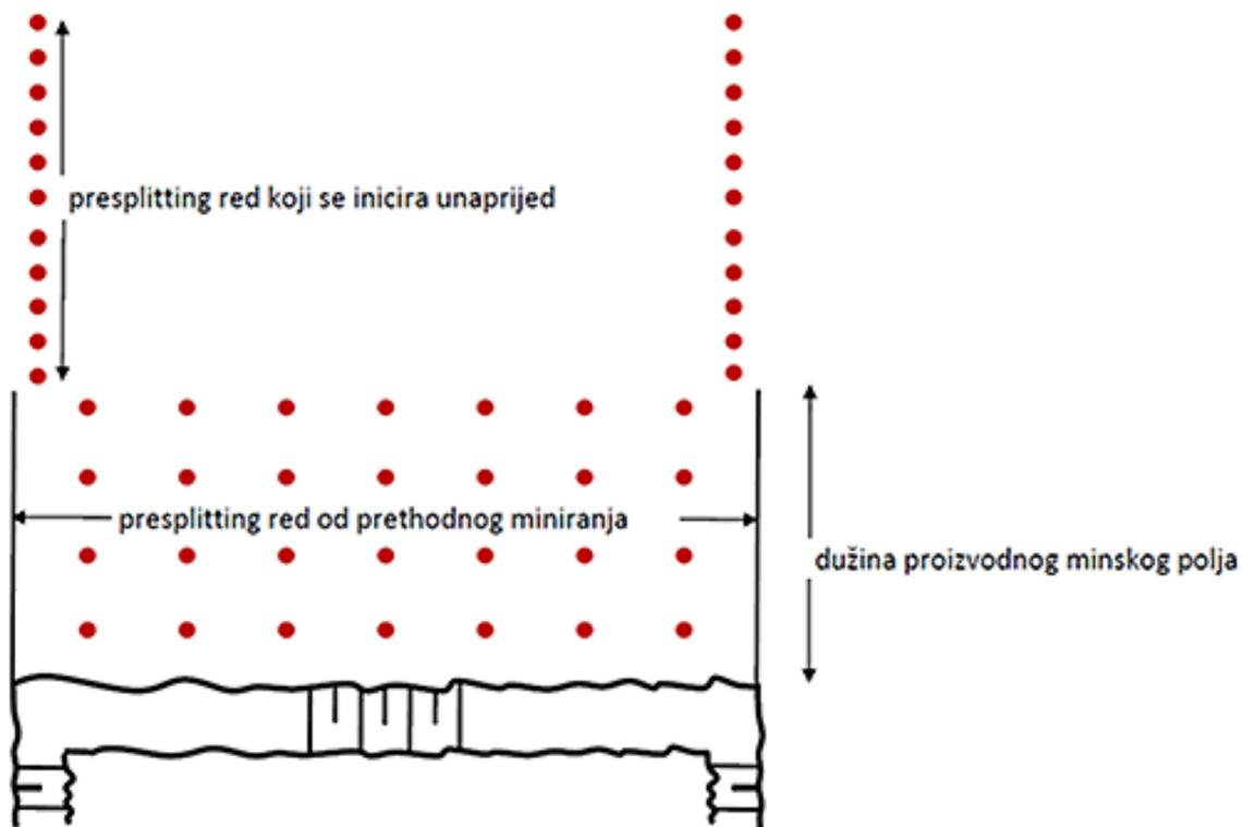
**Slika 3-14.** Izvedba prethodnog konturnog miniranja (Pisk 2011).
