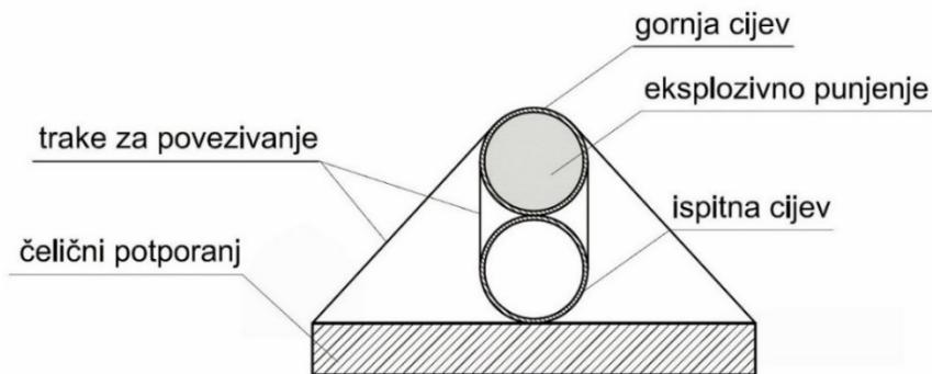
**Slika 6-26.** Shematski prikaz postava mjerena kod ispitivanja s dvostrukim cijevima
