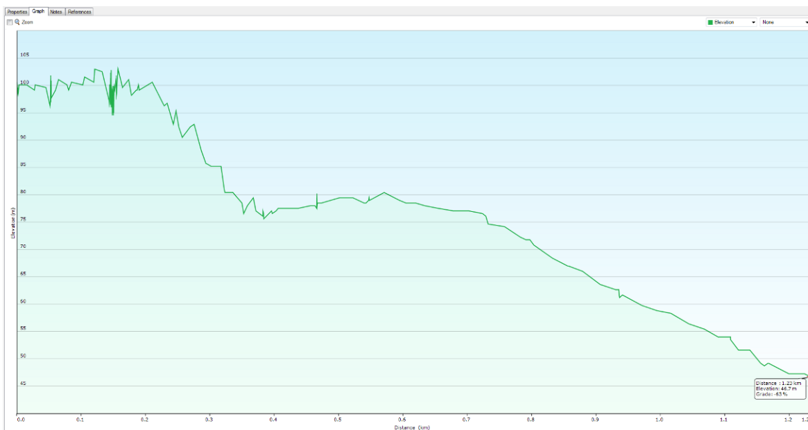
Slika 2-15. Uzdužni presjek trase od šeste etaže do drobilice (na apscisi prikazan pomak duž trase u kilometrima, na ordinati nadmorska visina u metrima)
