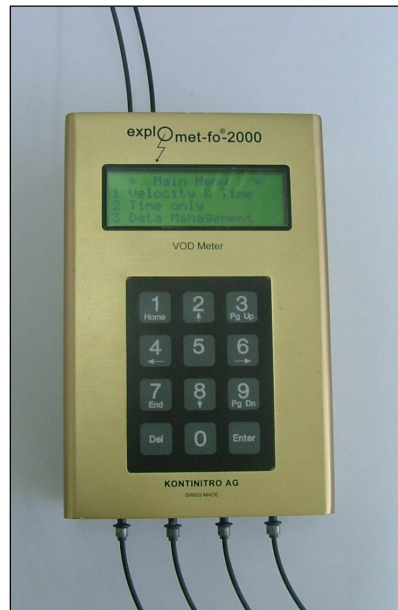
Slika 5-4. Elektronički sat Explomet – Fo 2000.
