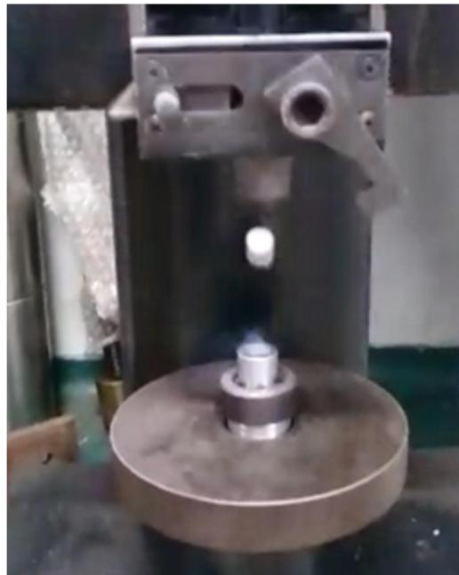
**Slika 5-11.** Fotografija reakcije prilikom određivanja osjetljivosti na udar.
