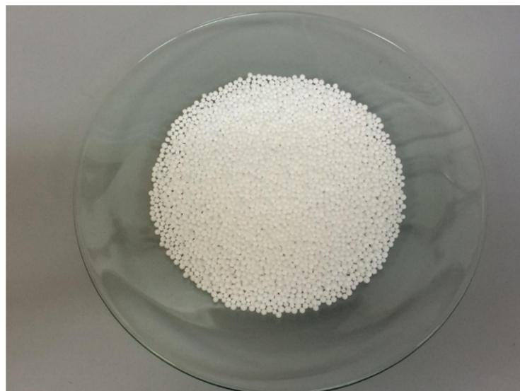
**Slika 5-2.** Granule ekspandiranog polistirena.
