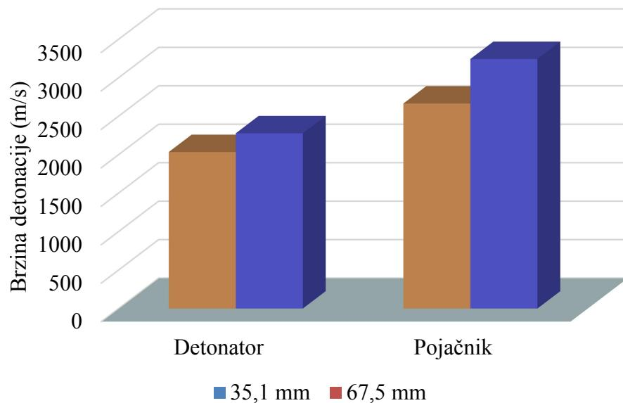
**Slika 6-2.** Zavisnost brzine detonacije od načina iniciranja.
