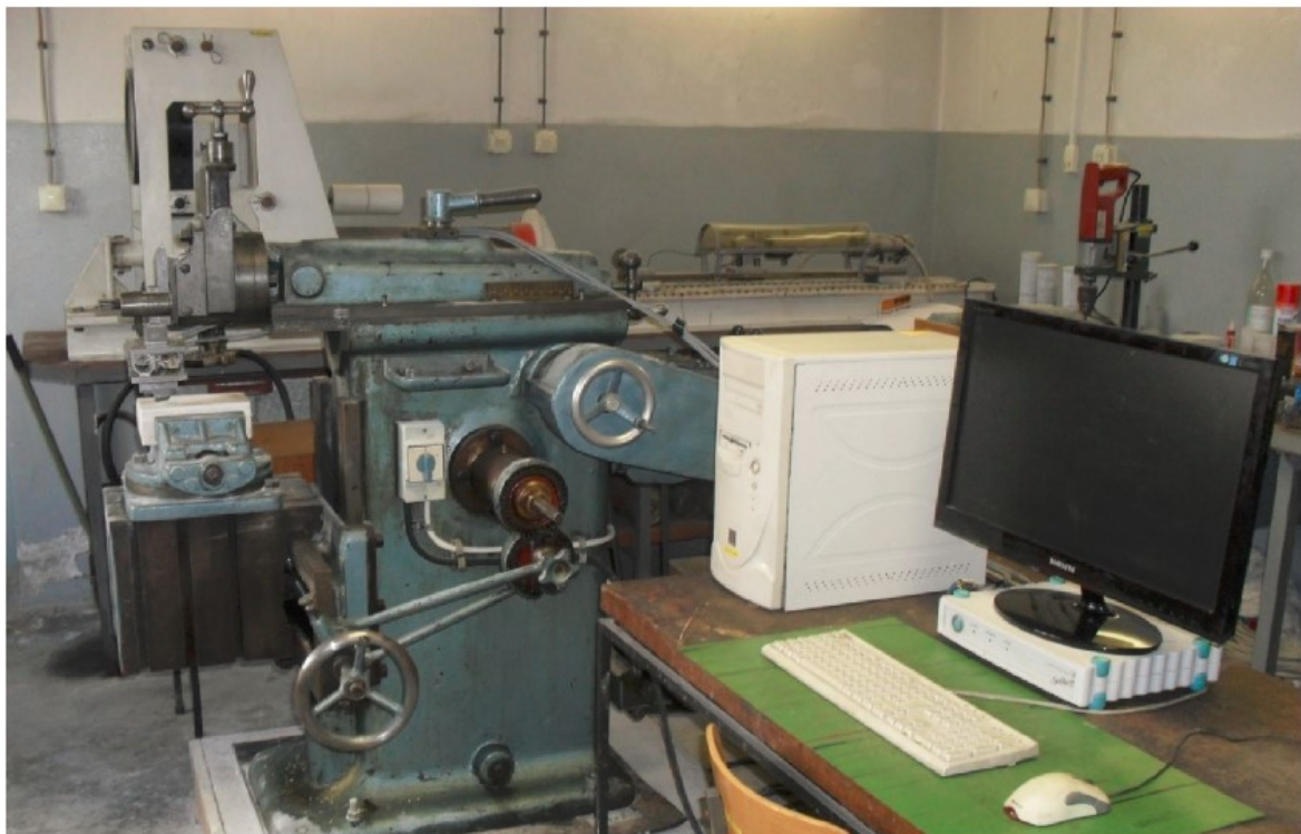
Slika 4-3. Uređaj za pravolinijsko rezanje s troosnim mjernim pretvornikom sile i mjerni sustav (Korman, 2014)
