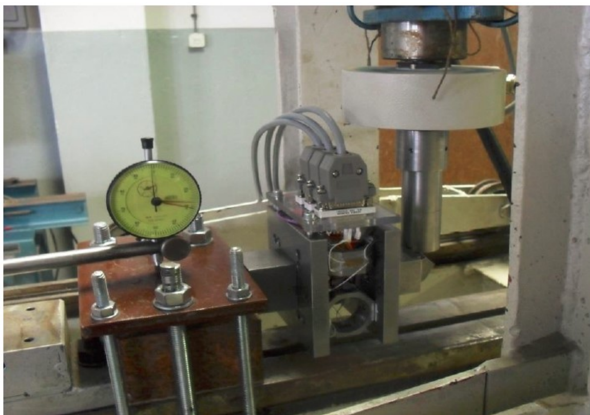
Slika 4-5. Uređaj za umjeravanje pretvornika sile (Korman, 2014)
