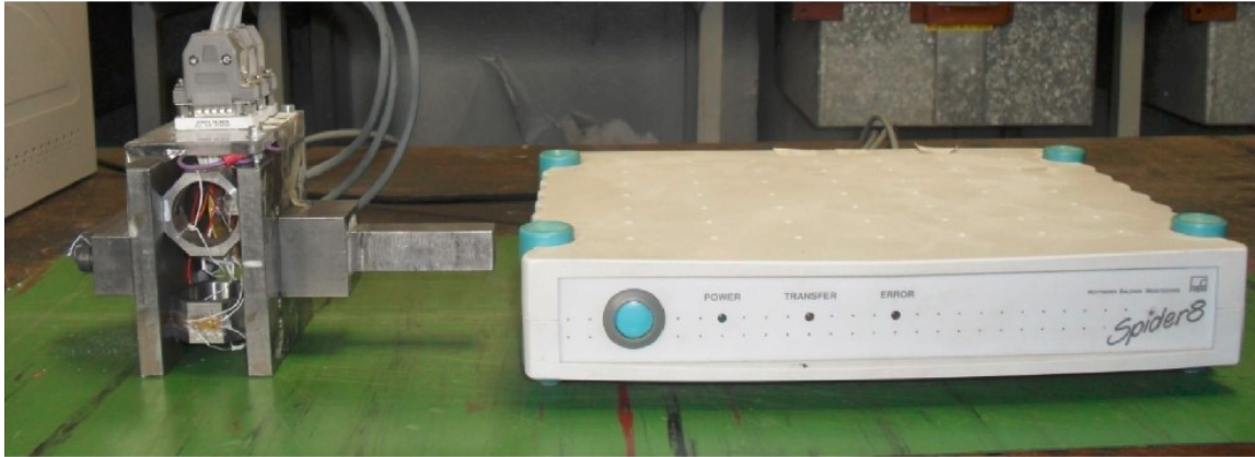
Slika 4-4. Mjerni pretvornik sile za mjerenje sile rezanja (Korman, 2014)
