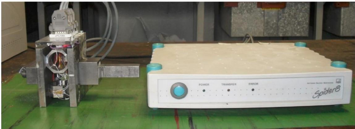
Slika 4-4. Mjerni pretvornik sile za mjerjenje sile rezanja (Korman, 2014)
