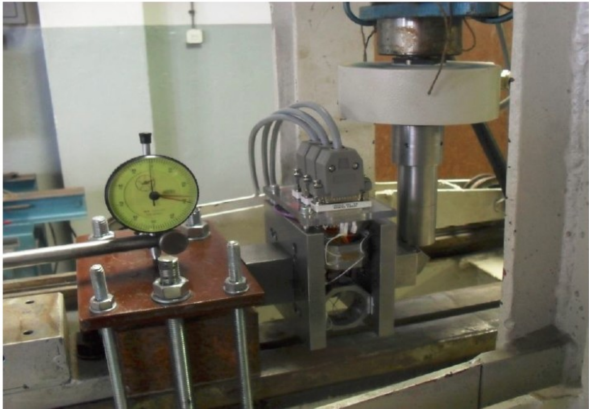
Slika 4-5. Uređaj za umjeravanje pretvornika sile (Korman, 2014)
