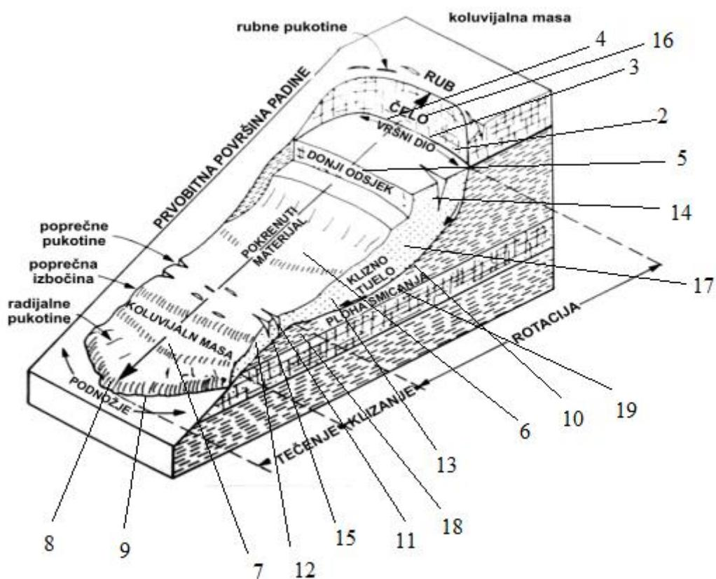
Slika 2-6. Dijelovi klizišta (brojevi se odnose na terminologiju navedenu u tablici 2-1
