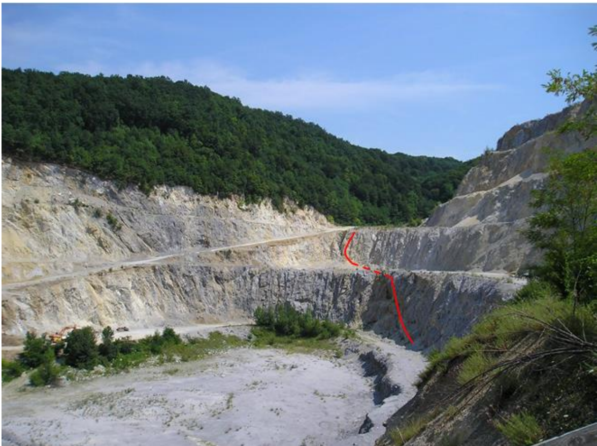
Slika 4-2. Središnji dio kamenoloma sa naznačenim rasjedom (Hrženjak i Navratil, 2013)
