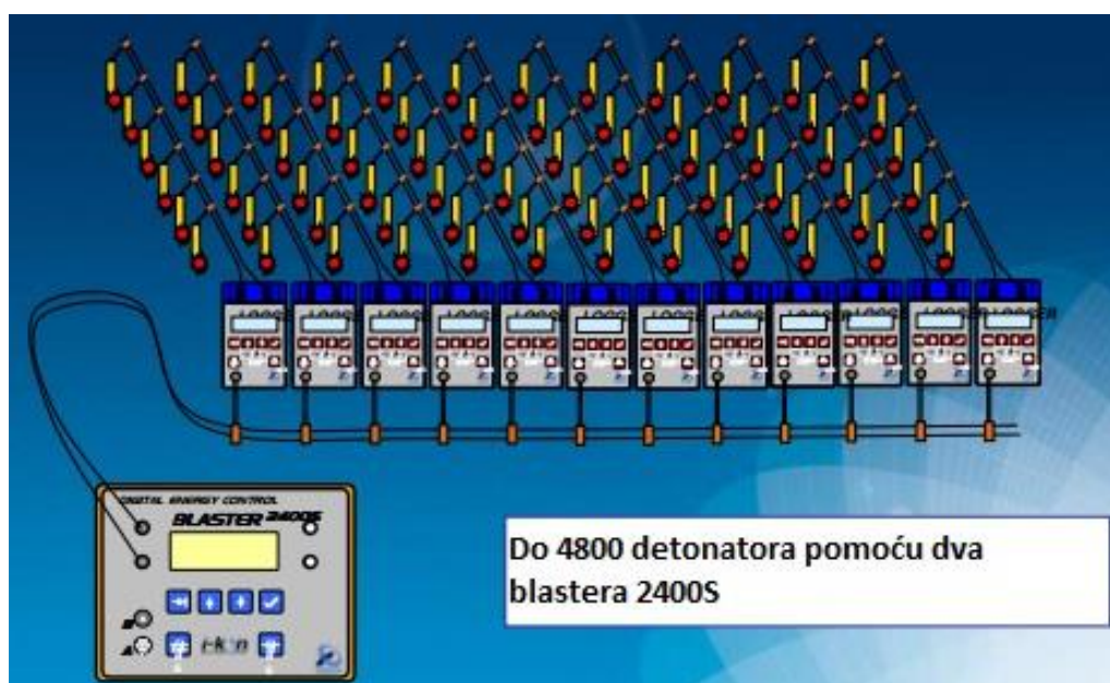
Slika 3-3. Postava blastera i programatora u minskom polju (Reinders 2010).
