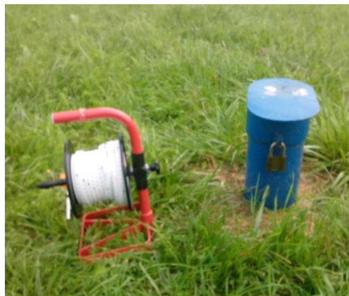
Slika 3.2. Piezometar Ž-8 i električni mjerac dubine do podzemne vode
