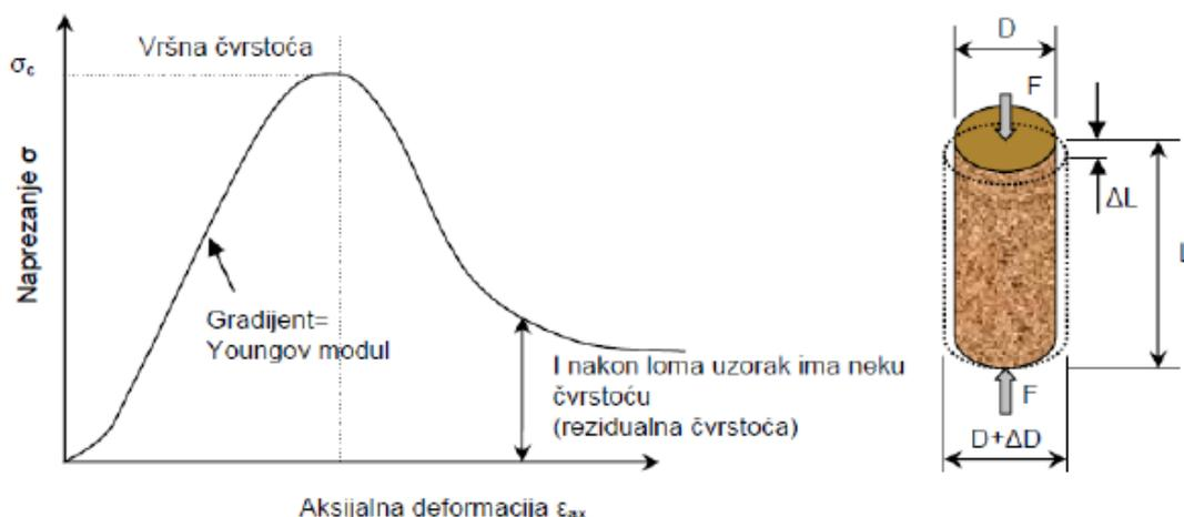
Slika 3-1 Prikaz odnosa naprezanja i deformacija (Vrkljan, 2013, prema Hudson and Harrison, 1997)
