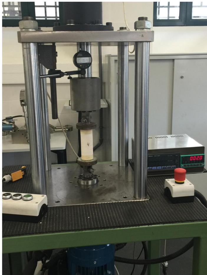
Slika 6-4 Ispitivanje vlačne čvrstoće uzorka direktnom metodom
