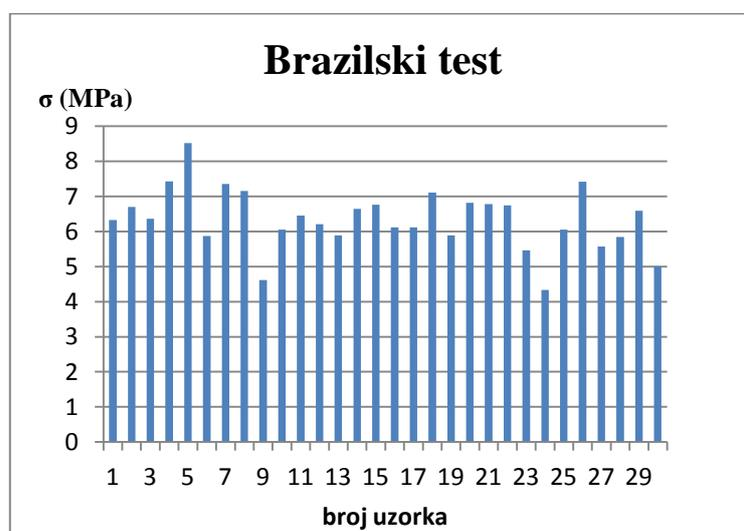
Slika 7-4 Dijagram s rezultatima ispitivanja Brazilskim testom
