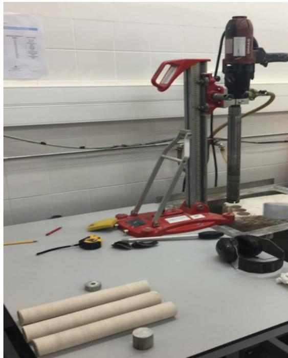
Slika 6-3 Rezanje i priprema uzoraka
