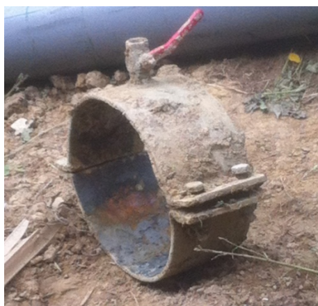
Slika 8-6. Ilegalni priključak u mjestu Štefanje
