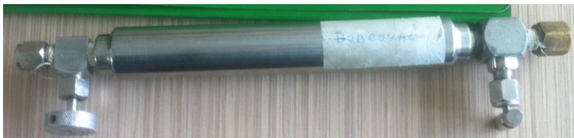
Slika 2-1. Boca za uzorkovanje prirodnog plina
