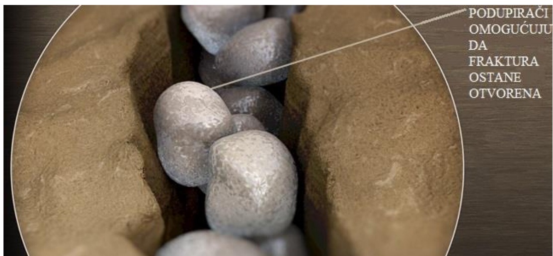
Slika 6.1. - Podupirači unutar frakture
