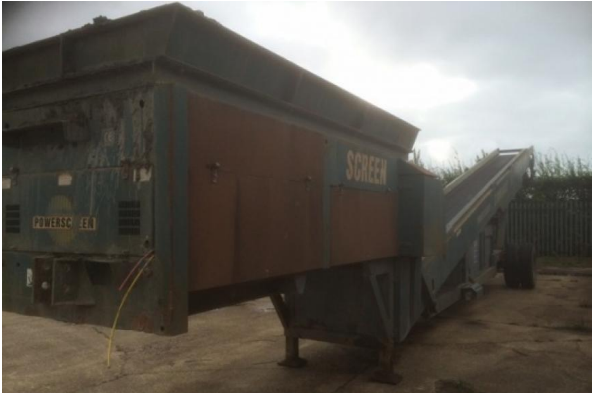
Slika 5-4. „Power commander“ pokretno postrojenje za sisanje
