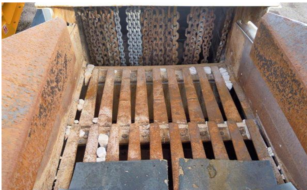
Slika 5-3. Vibracijska rešetka za odvajanje jalovine
