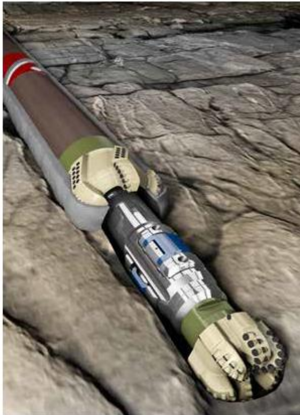
b) izvršena je cementacija, dlijeto se može probušiti sa PDC dlijetom i nastavlja se daljnje bušenje
