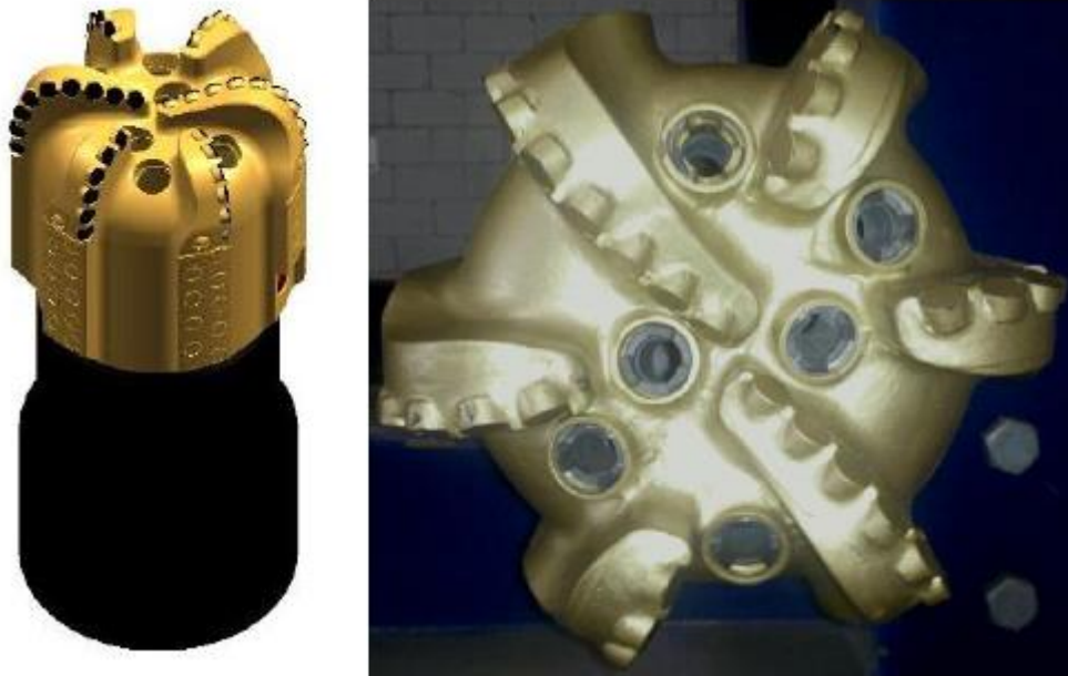
Slika 2-8. Polikristalno dijamantno dlijeto (Belloso et al., 2012)
