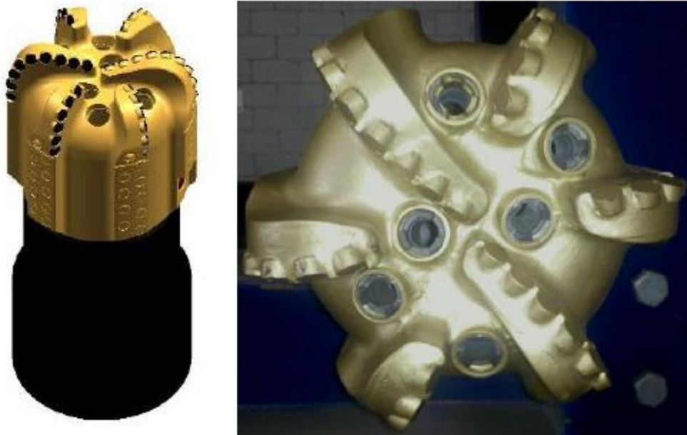
Slika 2-8. Polikristalno dijamantno dlijeto (Belloso et al., 2012)
