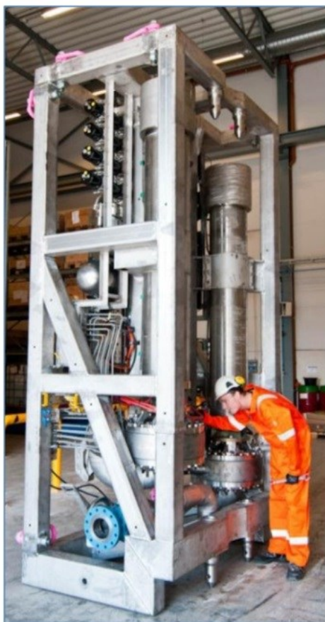
Slika 4-10. Podvodni pumpni modul (Rajabi et al., 2012).
