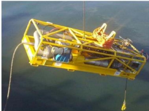
Slika 6-6. Podvodni pumpni modul (Choe et al., 2007).
