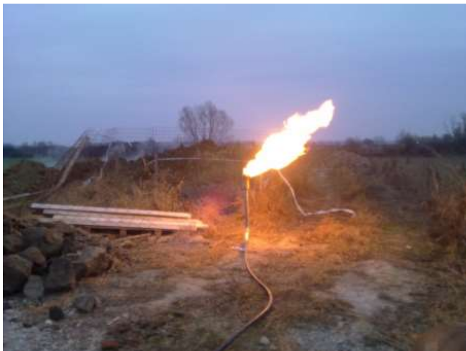
Slika 4-5. Spaljivanje plina na baklji
