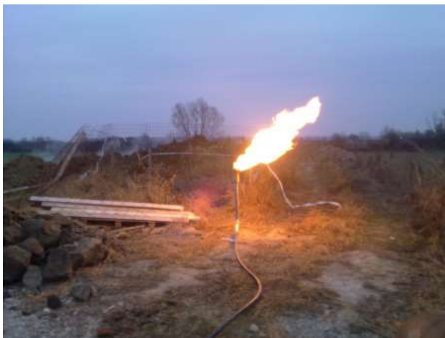
Slika 4-5. Spaljivanje plina na baklji
