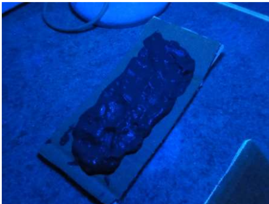
Slika 4-4. Tragovi nafte pod UV lampom na uzorku iz isplake
