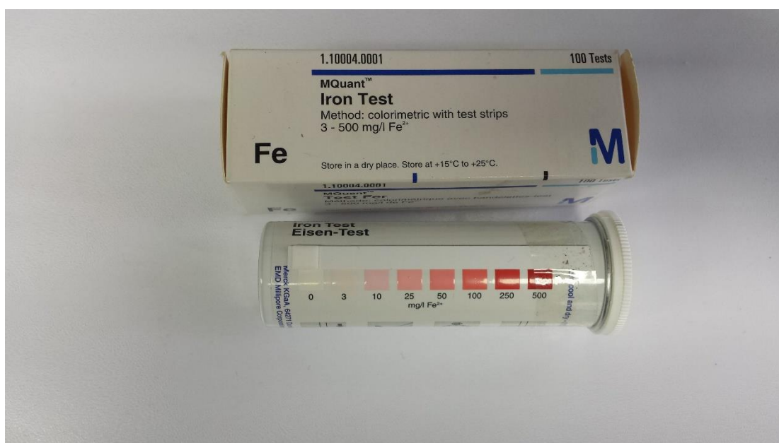
Slika 7-2. Kolorimetrijska kvantitativna metoda dokazivanja željeza.
