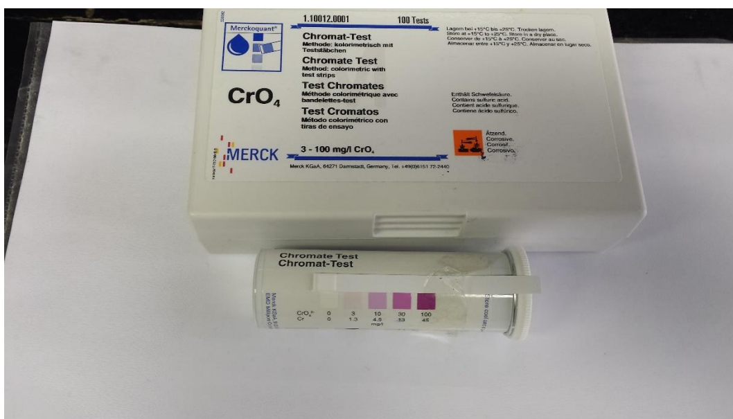
Slika 7-5. Kolorimetrijska kvantitativna metoda dokazivanja kroma.
