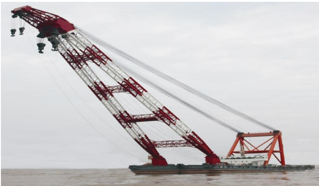
Slika 2-7. Barža sa „ sheerleg “ izvedbom dizalice (www.alibaba.com)
