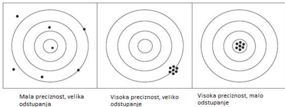
Slika 2-1 Grafički prikaz preciznosti i odstupanja mjerenja
