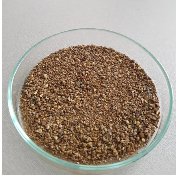
Slika 4-2. Granule bentonitne gline iz uzorka GCL-a (13-001-025)
