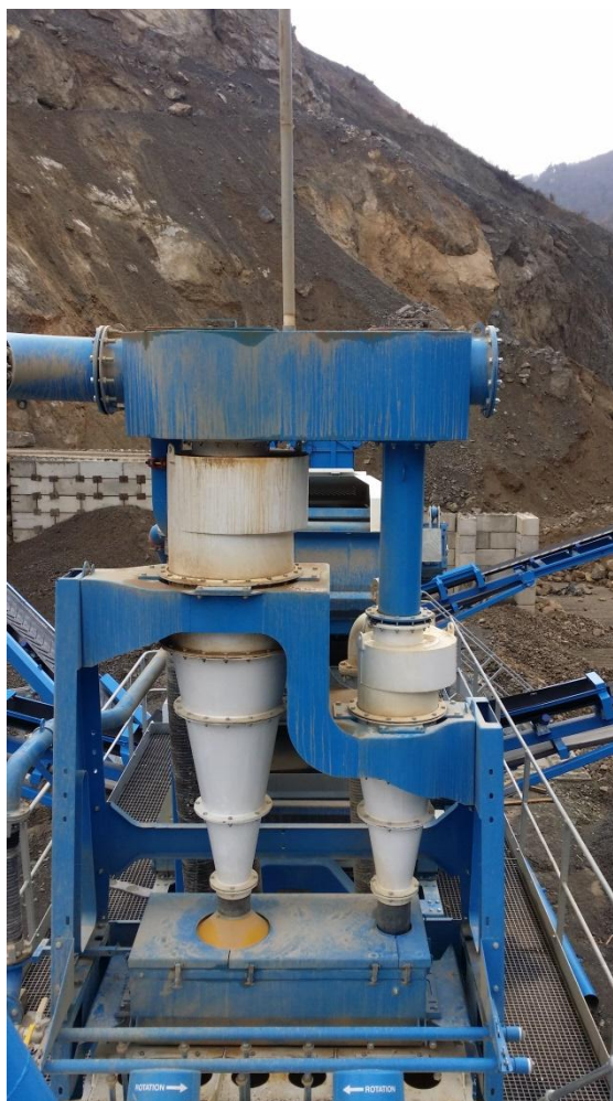
Slika 3-6. Dva hidrociklona različitih promjera povezana u seriju
