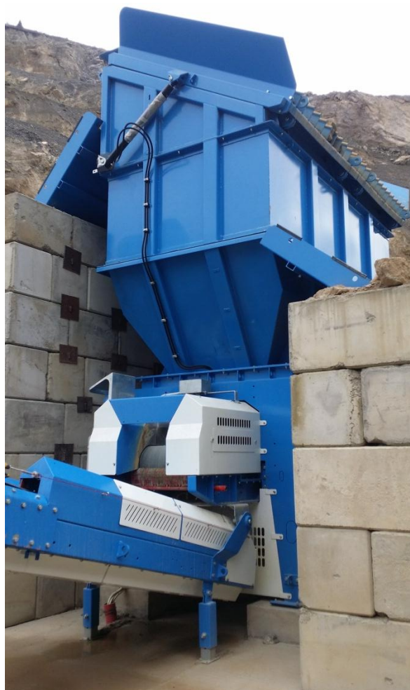
Slika 3-2. Usipni koš i trakasti dozator
