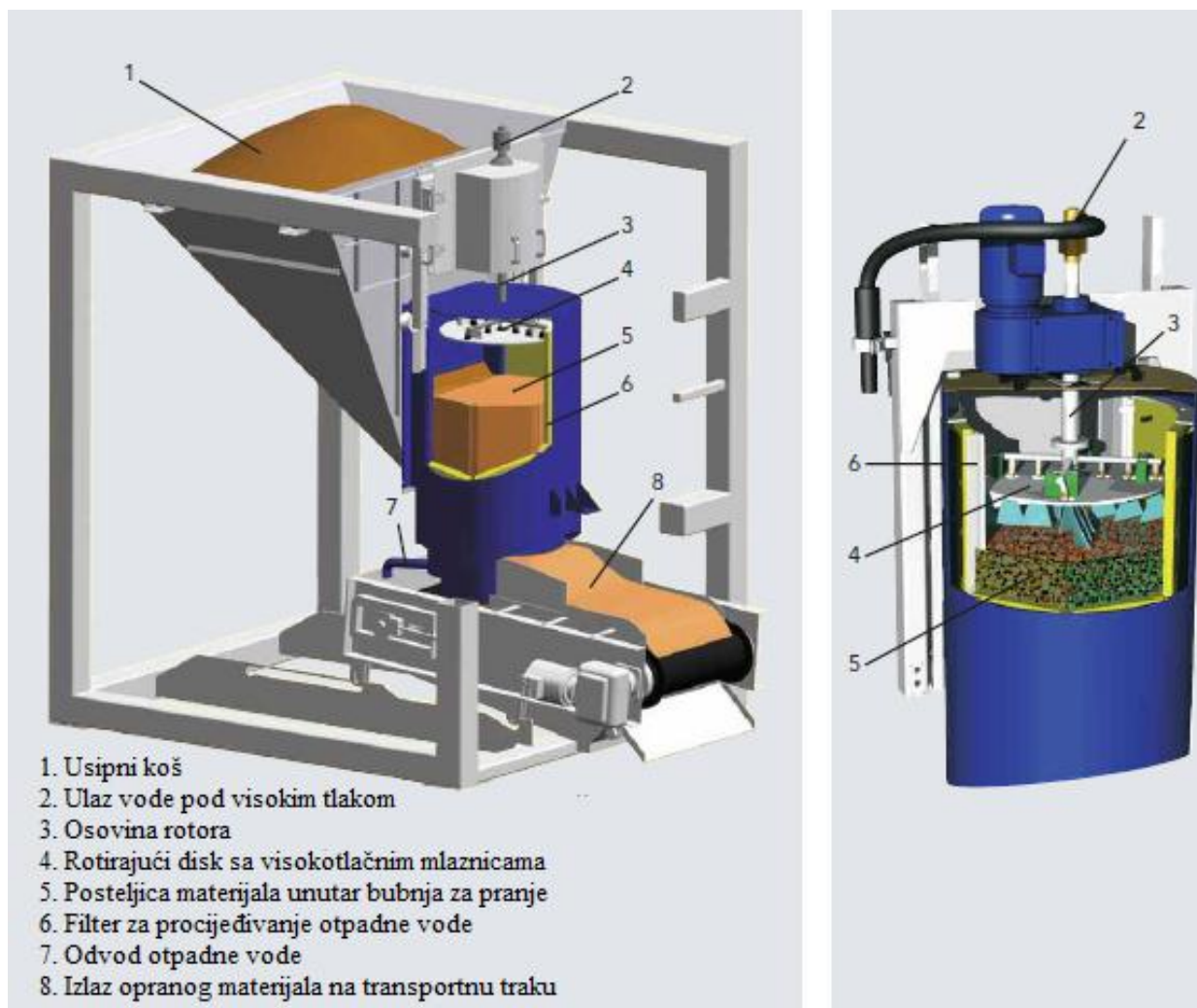
Slika 5-4. Komora za mokro oplemenjivanje pod visokim tlakom vode (Haver & Boecker 2014)
