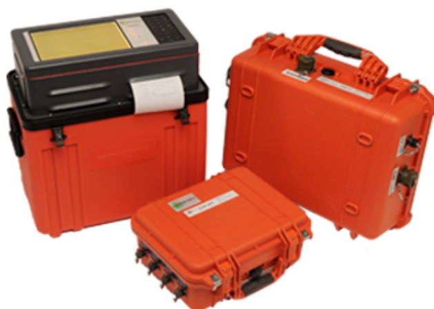
Slika 6-1. Magnetotelurska oprema STRATAGEM EH-4
