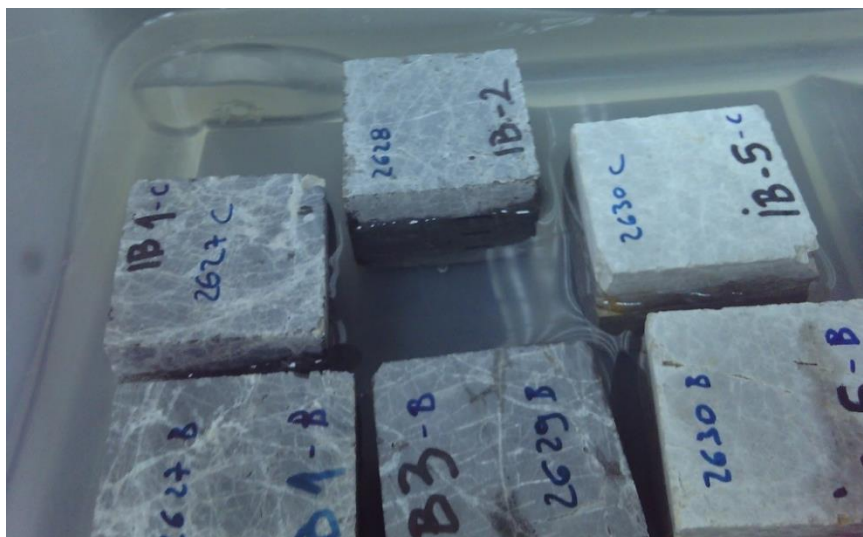
Slika 5.6. Uzorci potopljeni u vodi do 3/4 svoje visine
