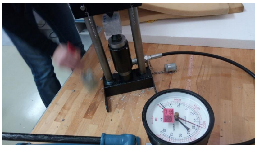
Slika 5.7. Uzorak postavljen za mjerenje PLT čvrstoće
