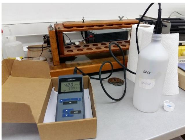
Slika 5.2. Mjerenje elektrovodljivosti uređajem Cond 3110
