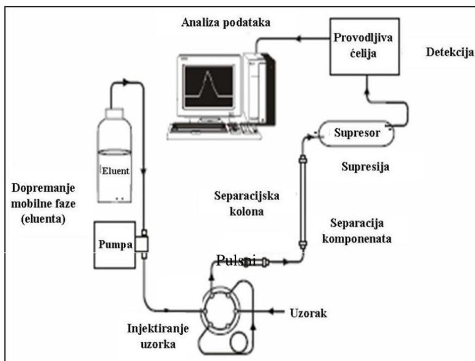
Slika 5.3. Shema rada ionskog kromatografa (modificirano prema Kralj, 2015)
