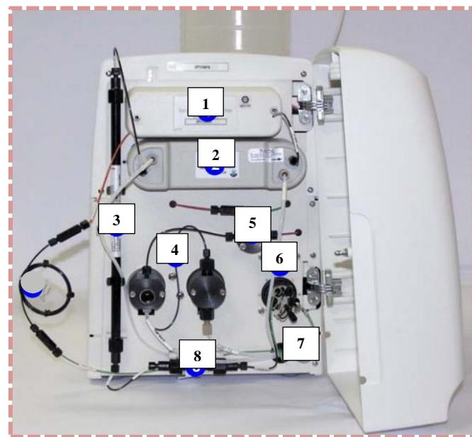
Slika 3 – 8. Dijelovi ionskog kromatograf; 1 – provodna čelija, 2 – supresor, 3 – separacijska kolona, 4 – pumpa, 5 – mjerač tlaka, 6 – injektor, 7 – cijev i 8 – pretkolona.
