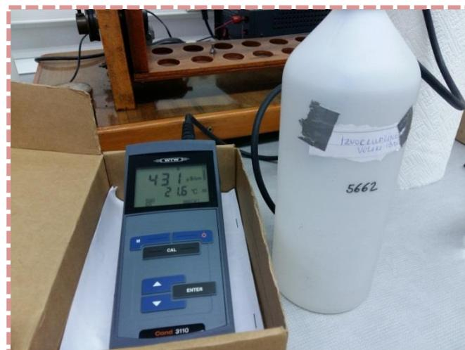
Slika 3 – 6. Mjerenje elektrovodljivosti
