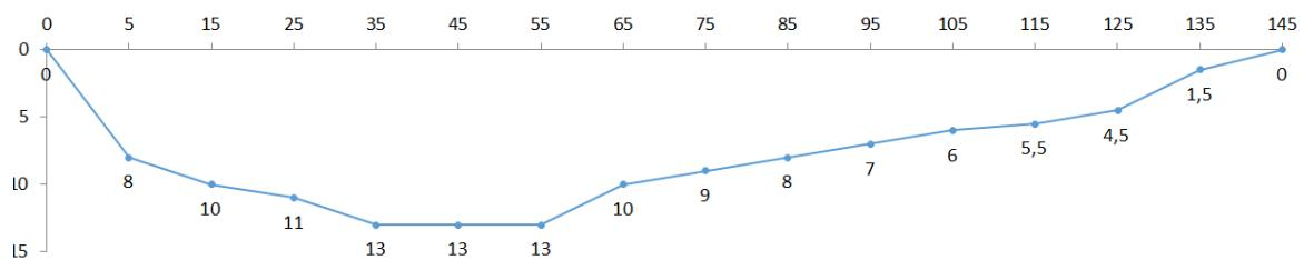
Slika 4 – 10. Prikaz mjernog profila vodotoka Jarak
