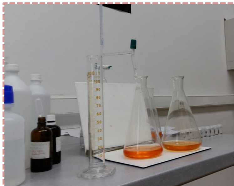
Slika 3 – 7. Titracija HCl-om uz indikator metil oranž (promjena boje u narančasto-smeđu)
