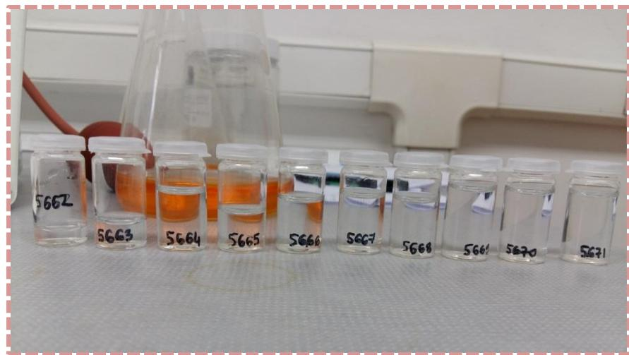
Slika 4 – 15. Filtrirani uzorci vode korišteni za ionsku kromatografiju
