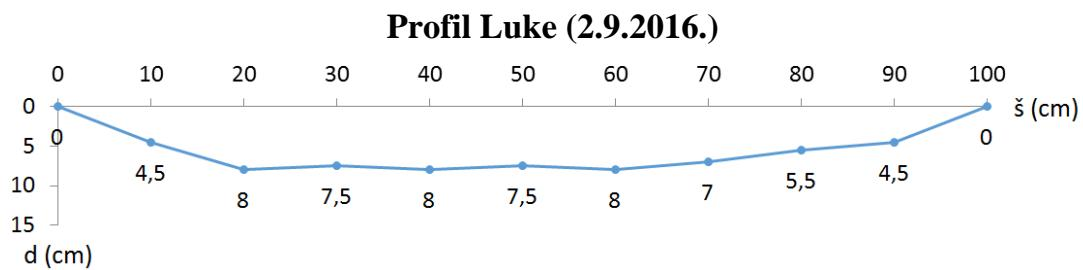
Slika 4 – 4. Prikaz mjernog profila vodotoka Luke
