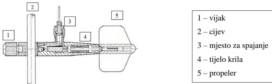
*Slika 3 – 2. Dijelovi hidrometrijskog krila (prema SEBA HYDROMETRIE, 2003)*
