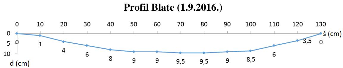
Slika 4 – 2. Prikaz mjernog profila vodotoka Blate
