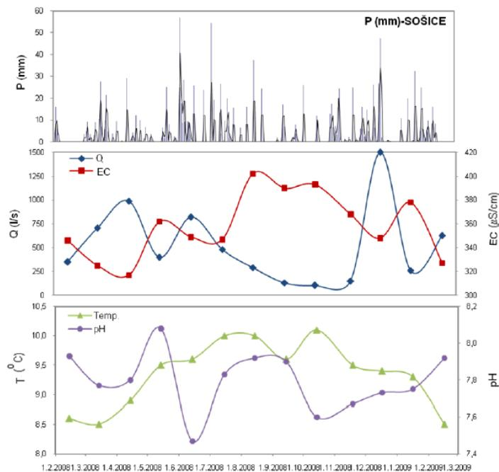
*Slika 2 – 14. Dnevne oborine na postaji Sošice u razdoblju od 1.veljača 2008. - 1.ožujka 2009.; vremenski dijagram izdašnosti svih izvora (Q), elektrovodljivosti (EC), temperature (T) i pH u razdoblju veljača 2008. - veljača 2009. godine (VUJNOVIĆ, 2010)*
