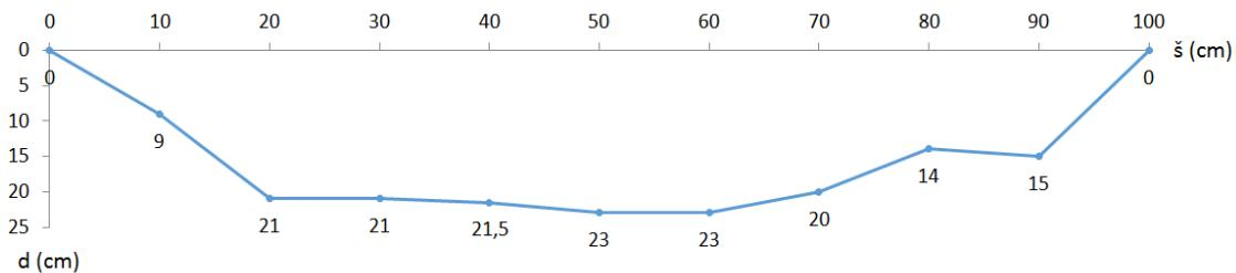
Slika 4 – 6. Prikaz mjernog profila starog toka Kupčine
