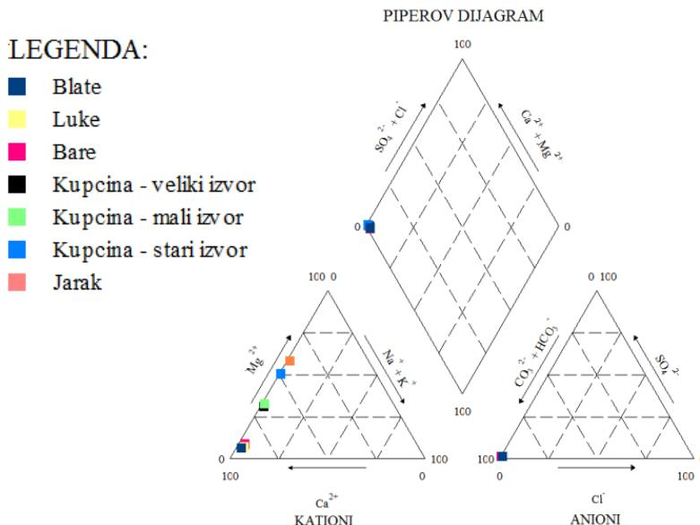
Slika 5 – 1. Piperov dijagram ispitivanih uzoraka
