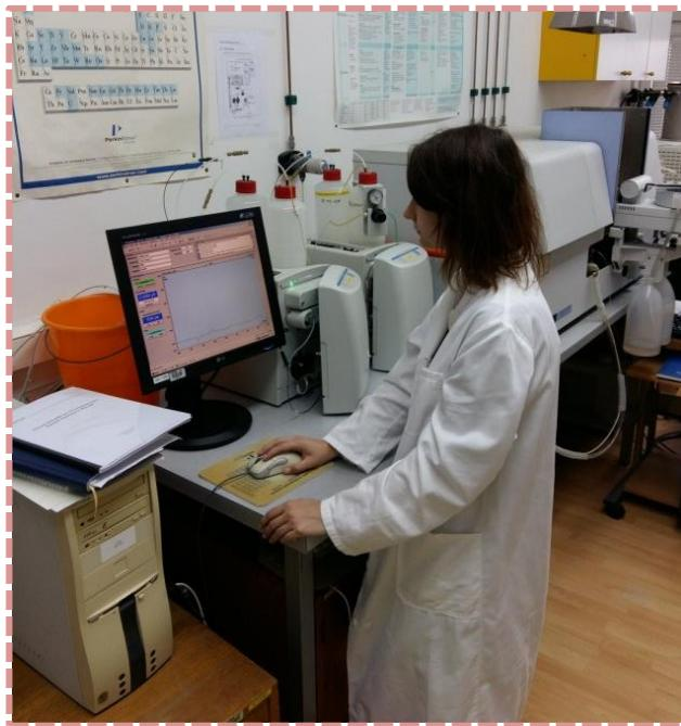
Slika 4 – 16. Praćenje mjerjenja ionskog kromatografa
