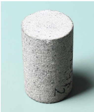
Slika 2-1 Uzorak jezgre stijene promjera 3,81 cm
