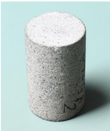
Slika 2-1 Uzorak jezgre stijene promjera 3,81 cm
