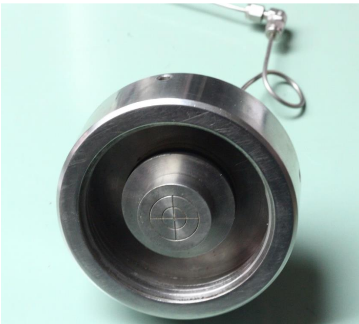
Slika 2-4 Element koji prijanja na bazu valjka uzorka stijene, na izlaznom poklopcu držača
