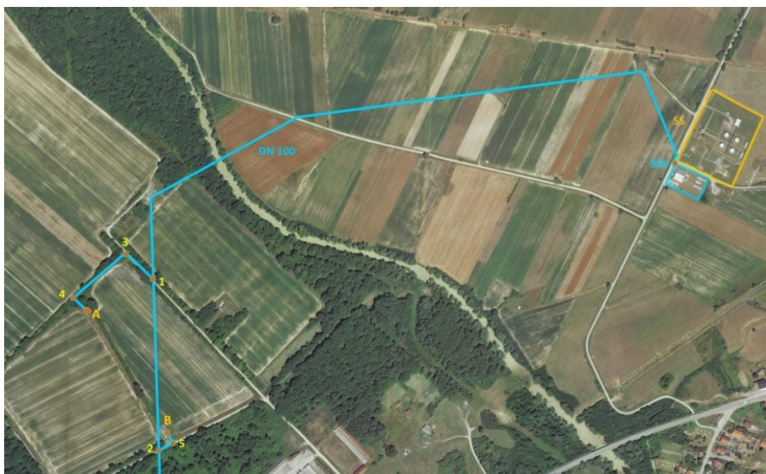
Slika 3-4. Trasa utisnog cjevovoda za utiskivanje vode
