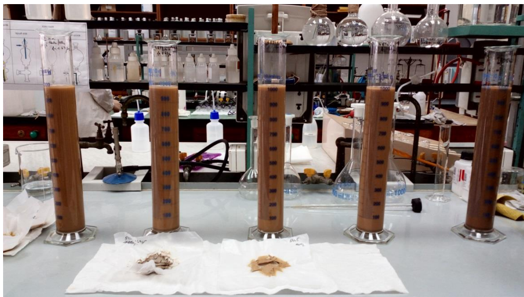
Slika 4-11. Izdvajanje frakcije < 2 \mu\text{m} iz suspenzije u cilindrima
