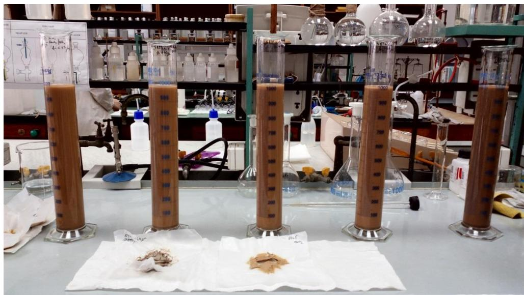
*Slika 4-11. Izdvajanje frakcije  $< 2 \mu\text{m}$  iz suspenzije u cilindrima*
