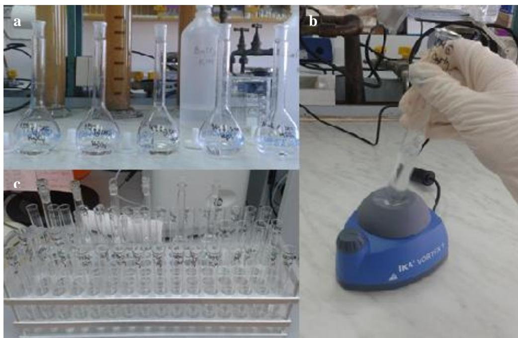
*Slika 4-5. Priprema uzorka za određivanje CEC-a i stupnja saturacije bazama a) Priprema uzorka za titraciju s  $MgSO_4$ ; b) mučkanje ekstrakta uzorka i reagensa pomoću uređaja IKA Vortex 1; c) 10 ml uzorka u epruvetama pripremljenih za analizu na AAS-u*
