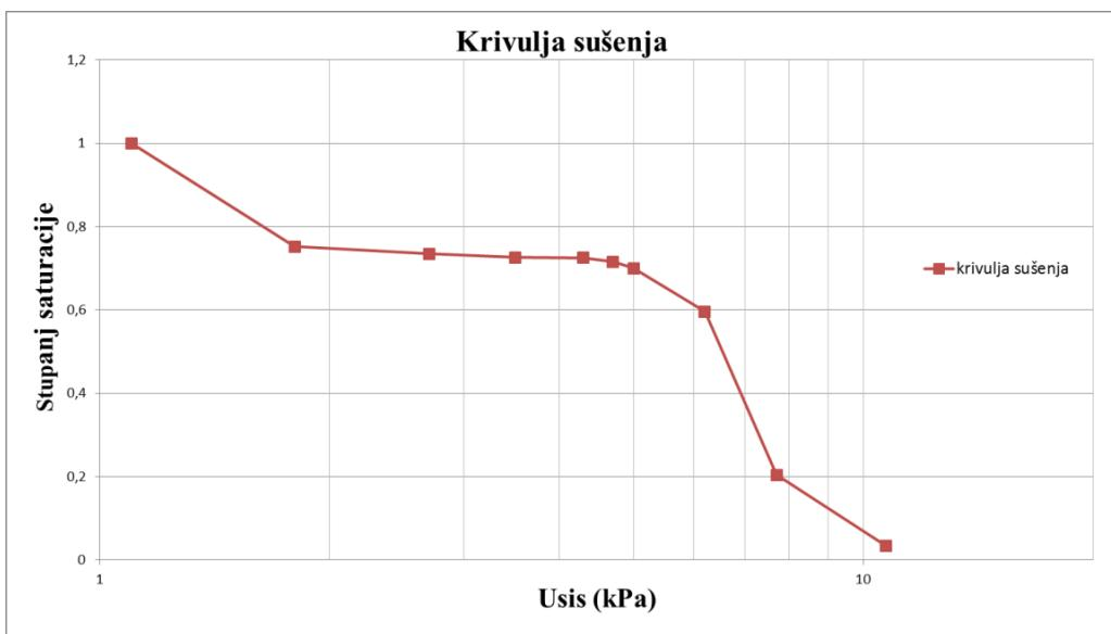
Slika 5-15. Dijagram stupnja saturacije uzorka u odnosu na usis, logaritamsko mjerilo (uzorak I, drugo mjerjenje)
