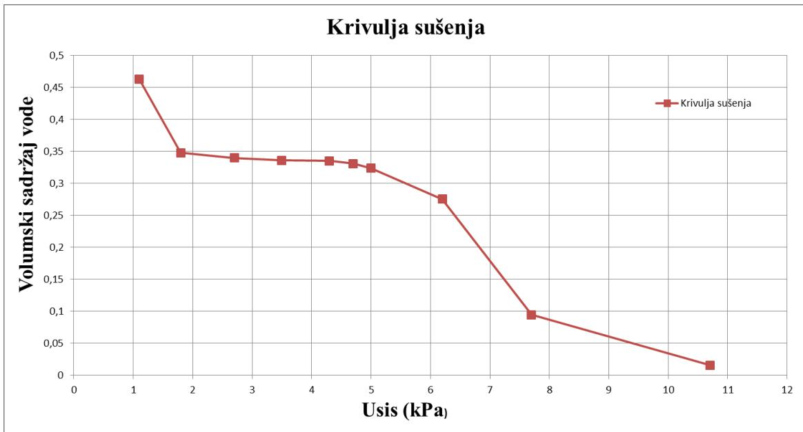
Slika 5-12. Dijagram volumnog sadržaja vode u odnosu na usis (uzorak I, drugo mjerjenje)
