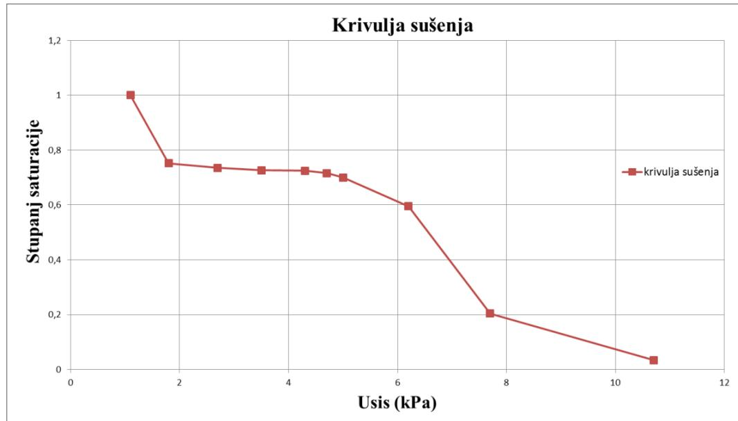
Slika 5-14. Dijagram stupnja saturacije uzorka u odnosu na usis (uzorak I, drugo mjerjenje)
