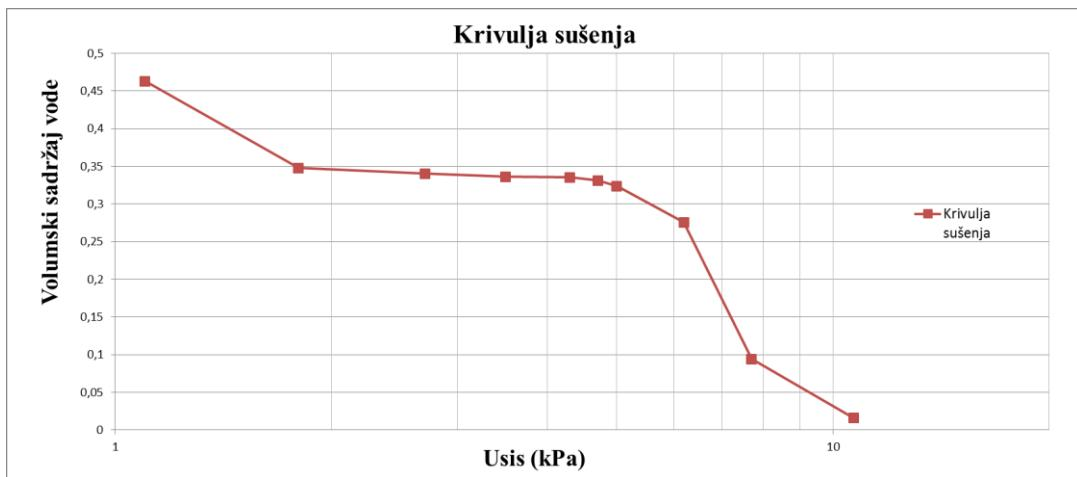
Slika 5-13. Dijagram volumnog sadržaja vode u odnosu na usis, logaritamsko mjerilo (uzorak I, drugo mjerjenje)
