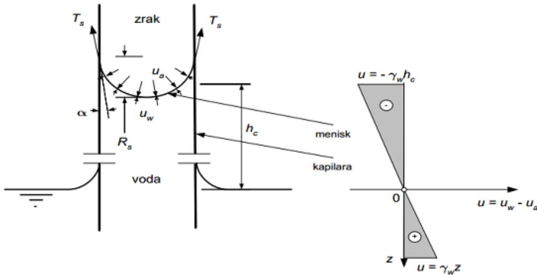
Slika 2-2. Shematski prikaz kapilarnih sila (Szavits-Nossan, 2012).
