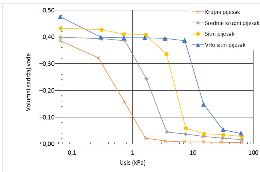
Slika 5-25. Krivulje retencije vode izmjerena u pijescima (Krupni pijesak, 710-2000  $\mu\text{m}$ ; Srednje krupni pijesak, 180-500  $\mu\text{m}$ ; Sitni pijesak, 105-220  $\mu\text{m}$ ; Vrlo sitni pijesak, 45-125  $\mu\text{m}$ ) (modificirano prema Bruand i dr., 2005).
