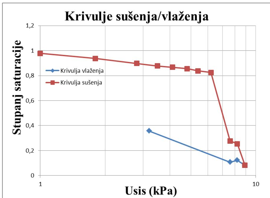
Slika 5-10. Dijagram stupnja saturacije uzorka u odnosu na usis, logaritamsko mjerilo (uzorak I, prvo mjerjenje)
