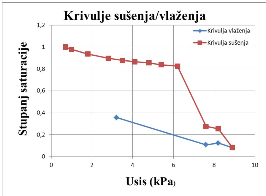
Slika 5-9. Dijagram stupnja saturacije uzorka u odnosu na usis (uzorak I, prvo mjerjenje)
