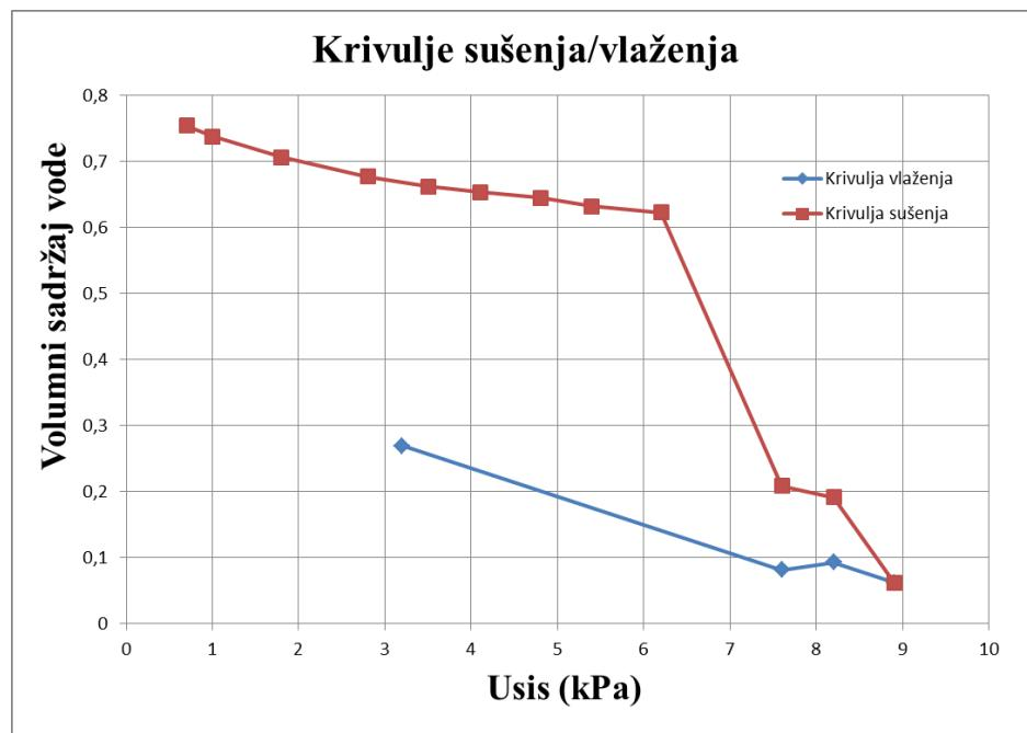
Slika 5-7. Dijagram volumnog sadržaja vode u odnosu na usis (uzorak I, prvo mjerjenje)
