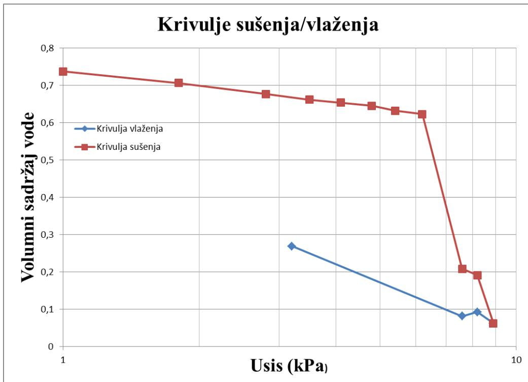
Slika 5-8. Dijagram volumnog sadržaja vode u odnosu na usis, logaritamsko mjerilo (uzorak I, prvo mjerjenje)
