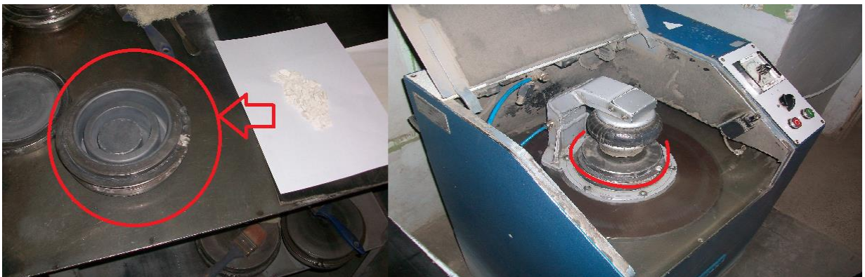
Slika 6-5. Herzog mlin (lijevo) i ćelija s prstenovima (desno).
