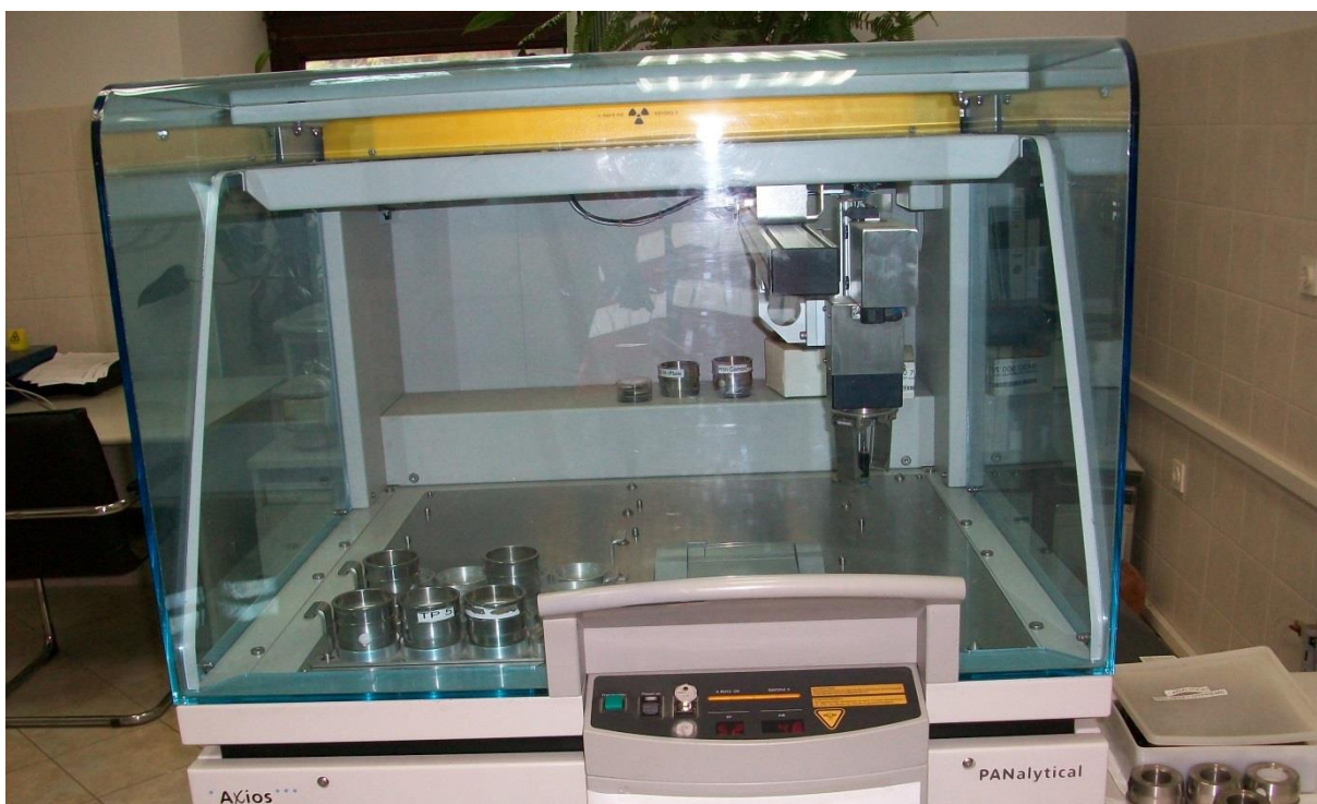
Slika 6-8. Instrument za rendgenske fluorescencije.
