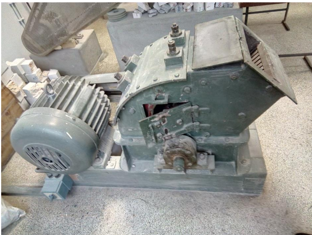
Slika 6-1 Laboratorijska udarna drobilica IZ-0 (Bedeković i Salopek, 2008)
