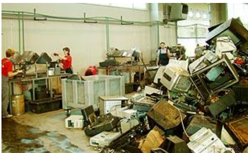
Slika 5-2 Rastavljanje EE otpada u firmi Flora Vtc (flora-vtc.hr, 2009)
