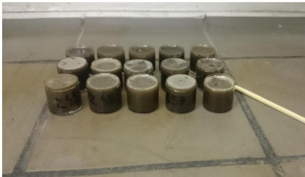
Slika 6.4. Uzorci pripremljeni sa smolom
