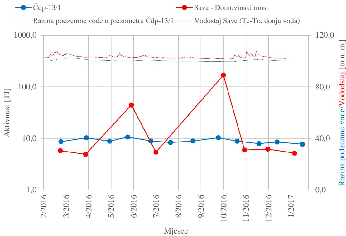
**Slika 6-11.** Mjerene koncentracije aktivnosti tricija u piezometru Čdp-13/1 i rijeci Savi te nivoogram piezometra Čdp-13/1 i Save
