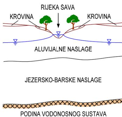
**Slika 4-3.** Shematski profil zagrebačkog vodonosnog sustava (Posavec, 2006)
