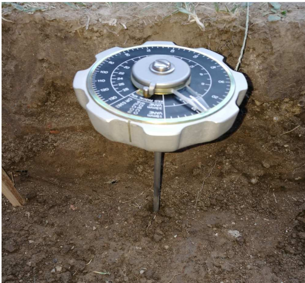
Slika 6-4 Krilna sonda utisnuta u tlo
