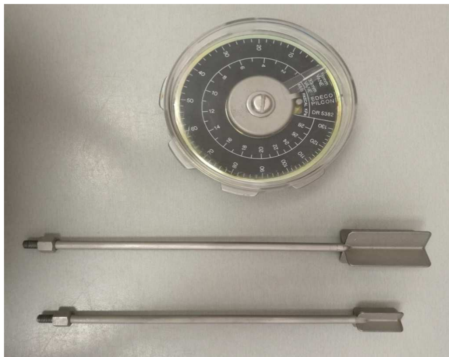
Slika 4-1 Okretna glava i krilca sonde ELE
