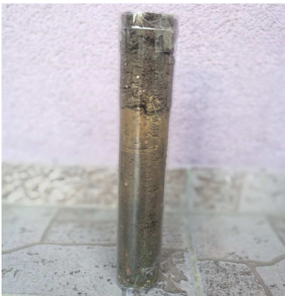
Slika 6-11 Uzorak tla u foliji izvađen na terenu
