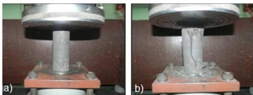
Slika 3.1. Laboratorijsko ispitivanje jednoosne tlačne čvrstoće na intaktnom uzorku stijene
