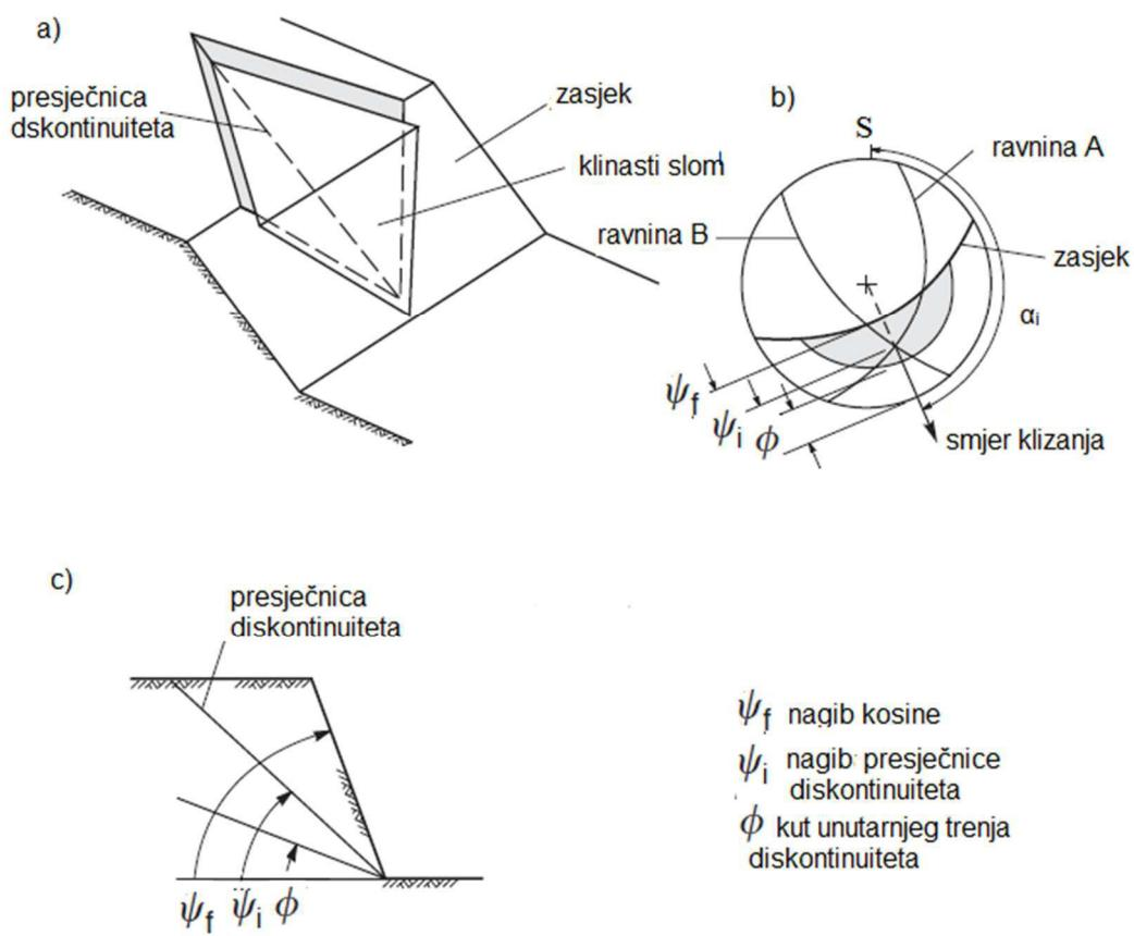
Slika 3.9. Geometrijski uvjeti potrebni za nastanak klinastog sloma: a) shematski prikaz klinastog sloma u stijenskoj masi, b) stereografski prikaz dvaju setova diskontinuiteta koji tvore klinasti slom; c) shematski presjek koji prikazuje položaj klizne plohe nastale klinastim slomom (modificirano prema Wyllie i Mah, 2005)
