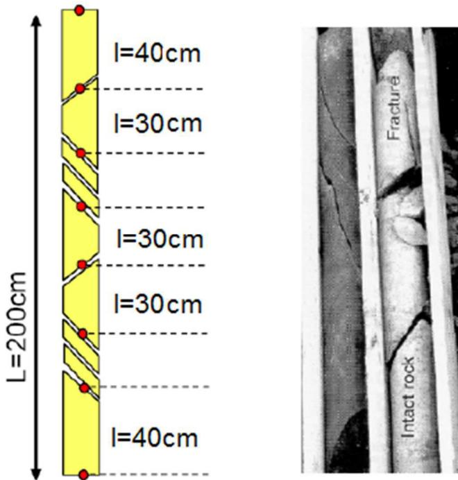
Slika 3.3. Procedura za mjerjenje i izračun RQD-a, pri čemu je L ukupna duljina jezgre, a l dijelovi jezgre veći od 10 cm (modificirano prema Deree i dr., 1967)
