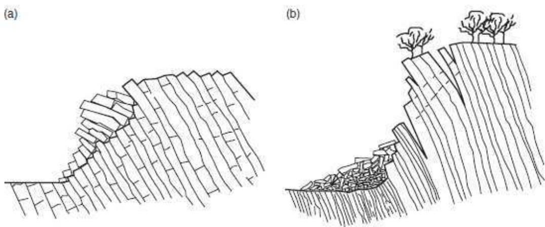
Slika 3.11. Shematski prikaz prevrtanja: a) prevrtanje nastalo kombinacijom dvaju približno okomitih setova diskontinuiteta i b) prevrtanje savijanjem nastalo jednom setom diskontinuiteta (b) (modificirano prema Wyllie i Mah, 2005)
