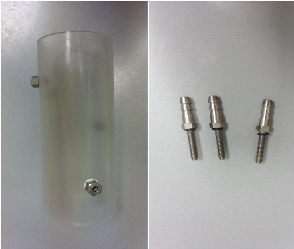
Slika 6.2. Čelija permeametra i odgovarajući manometri
