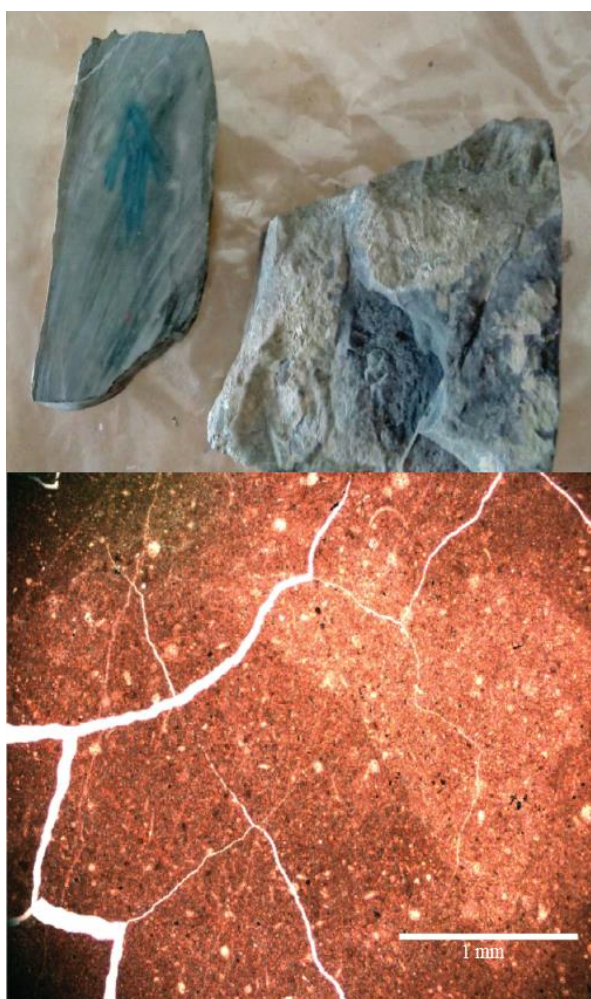
Slika 6.10. Uzorak iz sloja 23 sa trošnom površinom (gore) i mikrit vidljiv mikroskopskim pregledom uzorka (dolje).
