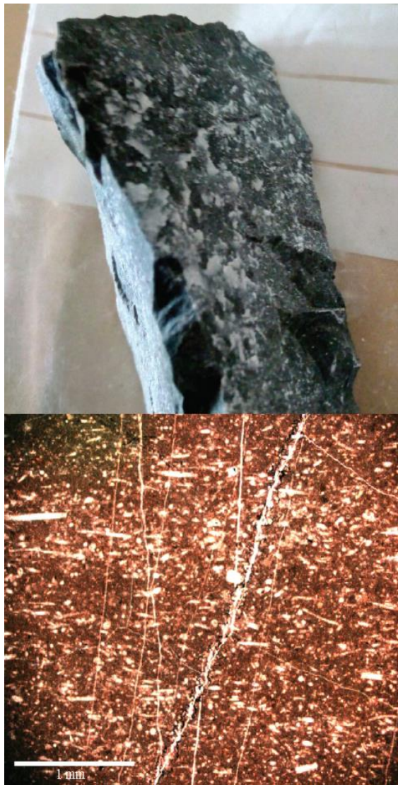
Slika 6.9. Uzorak iz sloja 17 s kalcitnim žilama i znakovima trošenja (gore), mikroskopski preparat na kojem su vidljivi fosilni ostaci vapnenačkih spužvi (dolje).
