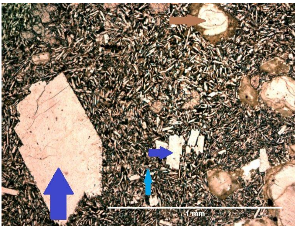
Slika 5.3.17. Mikrofotografija uzorka ZB – 3 kojom se ilustrira sastav bazalta. Tamno plave strelice prikazuju fenokristale plagioklasa, svijetlo plava strelica prikazuje klinopiroksen u sastavu vulkanske osnove. Smeđa prikazuje nodulu sekundarno ispunjenu kalcitom.
