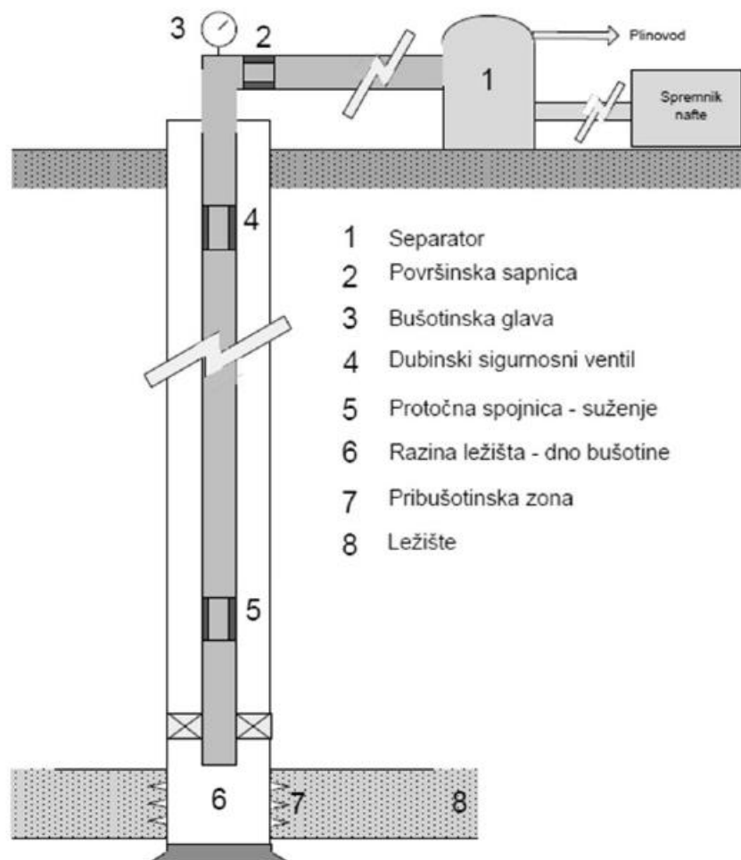
Slika 4-1. Smještaj najčešćih čvorišta proizvodnog sustava bušotine (Čikeš, 2015)
